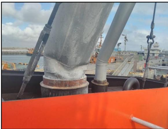
圖 2 臺港 15001 煙囪排氣管變形
