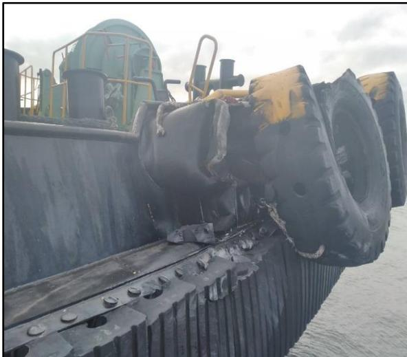
圖 6 臺港 15001 右船艏破洞
