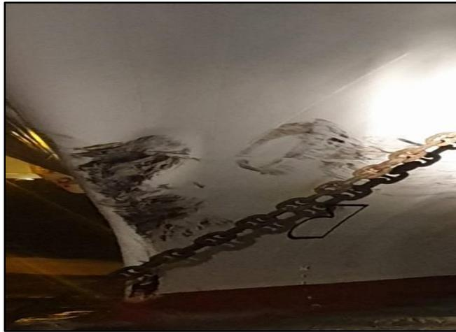
圖 1 中遠之星左舷船艏凹陷
