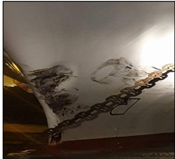
圖 7 中遠之星左舷船艏凹陷
