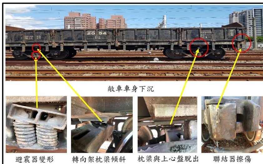
圖 1.3 30G2054 敞車損害情形示意圖
