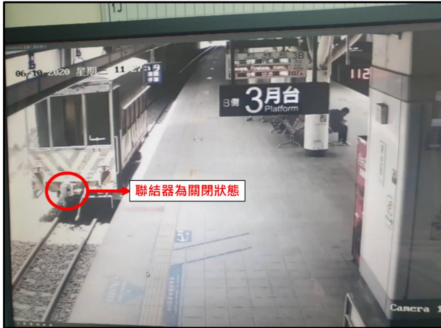
圖 1.11-9 守車發生溜逸後行經新左營站 (2)
