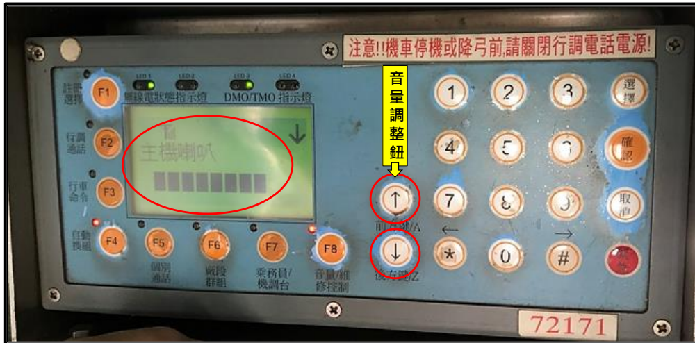
圖 1.9-1 行調無線電車上台音量調整方式
