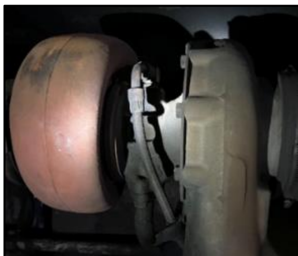
圖 1.13-2 事故車輛其它渦輪增壓機（未裝隔熱罩）
