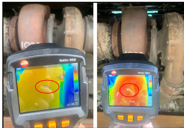
圖 1.13-3 2721 次車渦輪增壓機運作溫度實地量測
