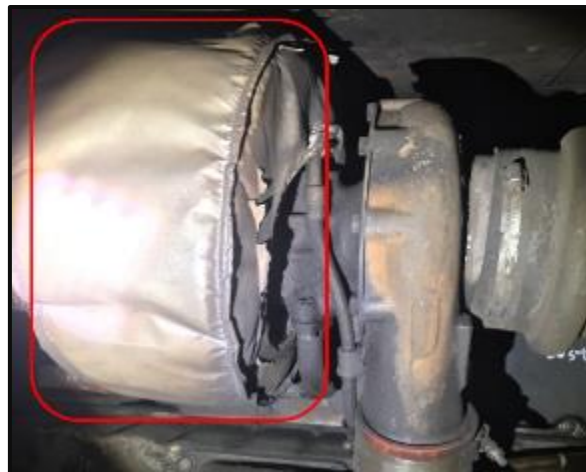
圖 1.13-1 事故車輛使用之渦輪增壓機隔熱罩
