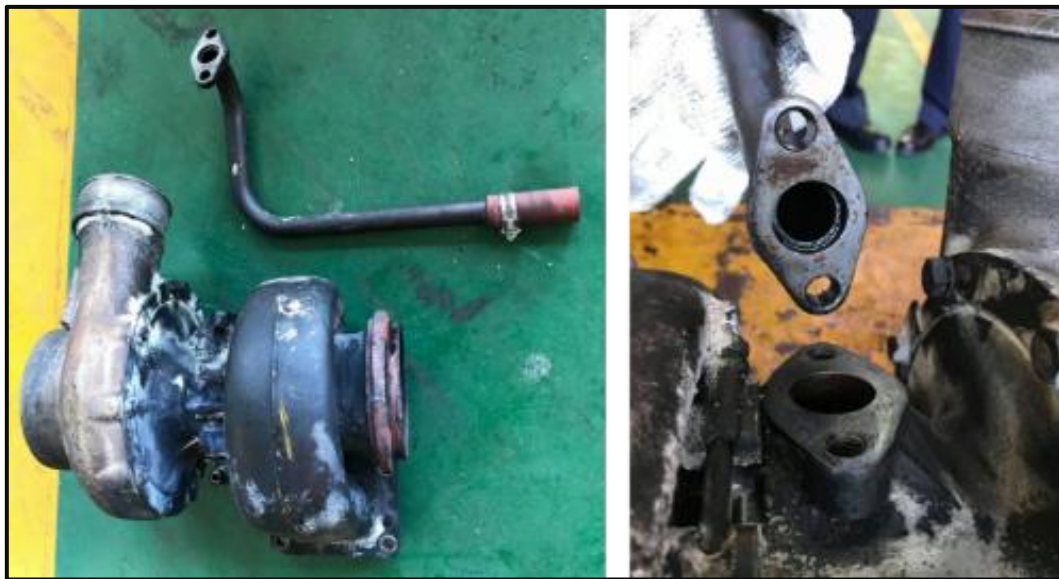
圖 1.8-6 潤滑油回油管與渦輪增壓機接合處
