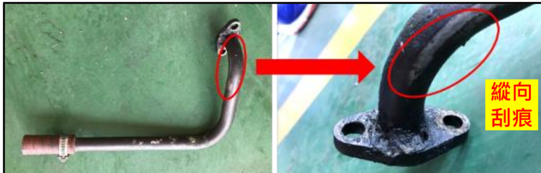
圖 1.8-11 回油管下方彎曲處左側縱向刮痕
