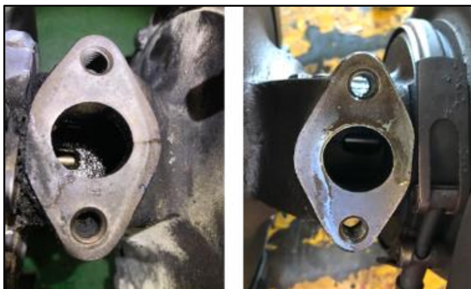
圖 1.8-17 渦輪增壓機螺孔內部螺紋狀態
