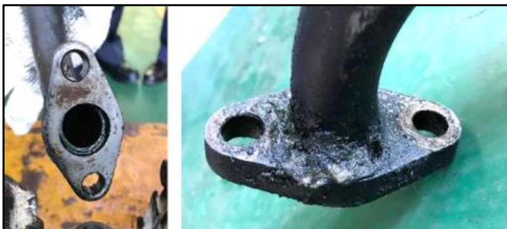
圖 1.8-16 回油管螺孔內部狀態
