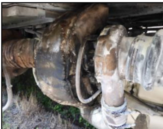
圖 1.1-1 車底左(山)側渦輪增壓機與護罩損毀
