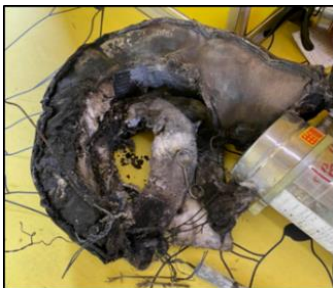
圖 1.1-2 渦輪增壓機護罩火災殘骸
