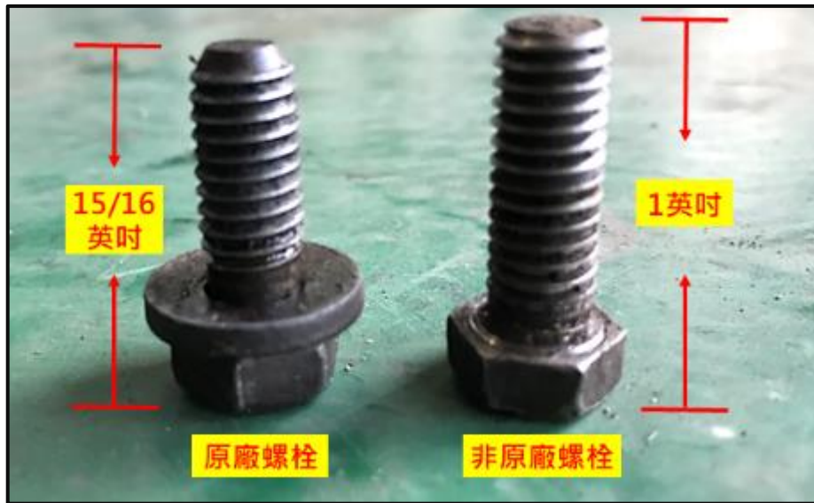
圖 1.8-14 事故列車編組回油管接合處使用之不同型式螺栓
