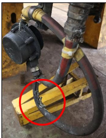
圖 1.3-3 轉速計電線燒損情形
