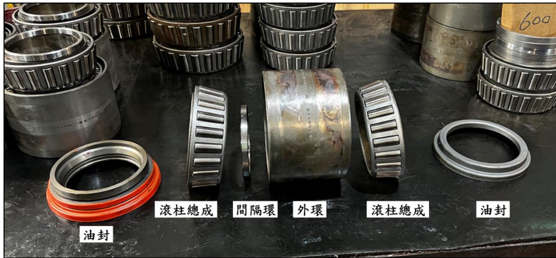
圖 1.7-1 與事故列車所用同型軸承拆解部件
