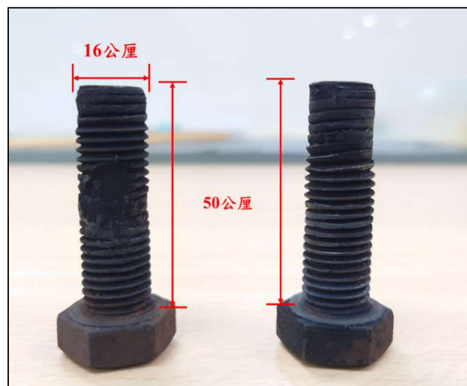
圖 1.3-7 螺絲損害情形及尺寸
