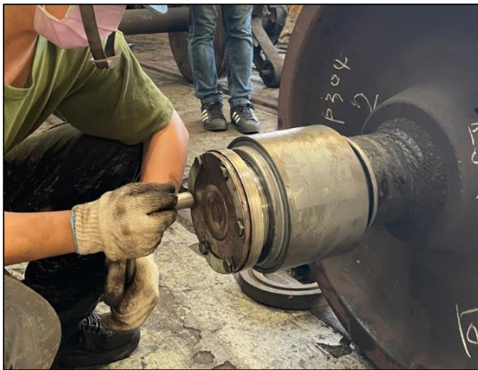
圖 1.11-6 外包維修人員鎖車軸外蓋
