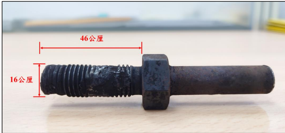
圖 1.3-8 轉速計螺絲損害情形及尺寸
