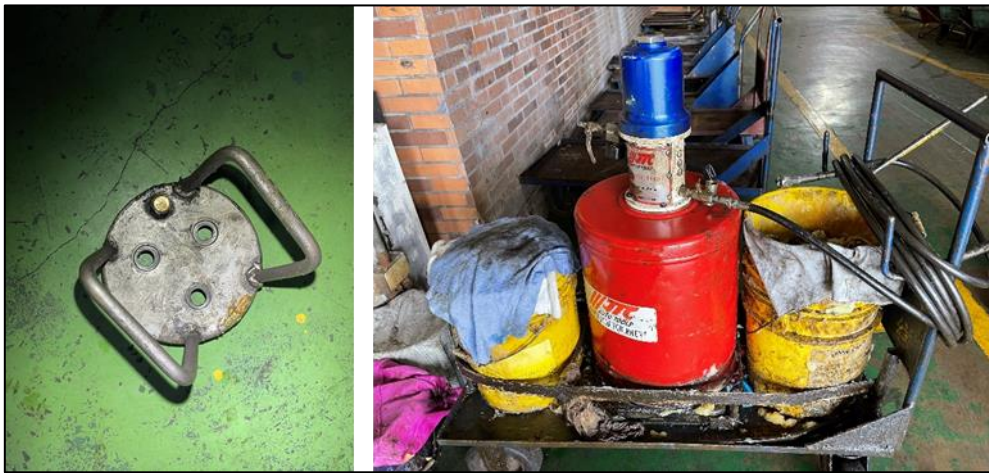
圖 1.11-7 加脂用軸端蓋（左）及氣動黃油機（右）
