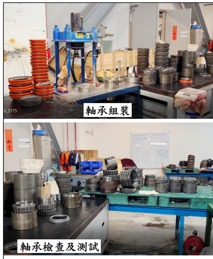
圖 1.11-12 軸承檢查、組裝及測試作業區
