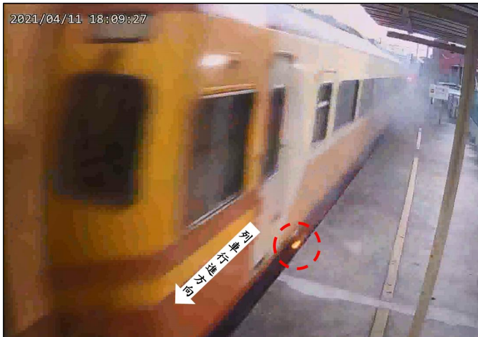
圖 1.9-3 事故列車進入中壢站 1 月台南端影像 事故列車於中壢站停妥後，車站人員使用滅火器對起火處噴灑， 如圖 1.9-4。
