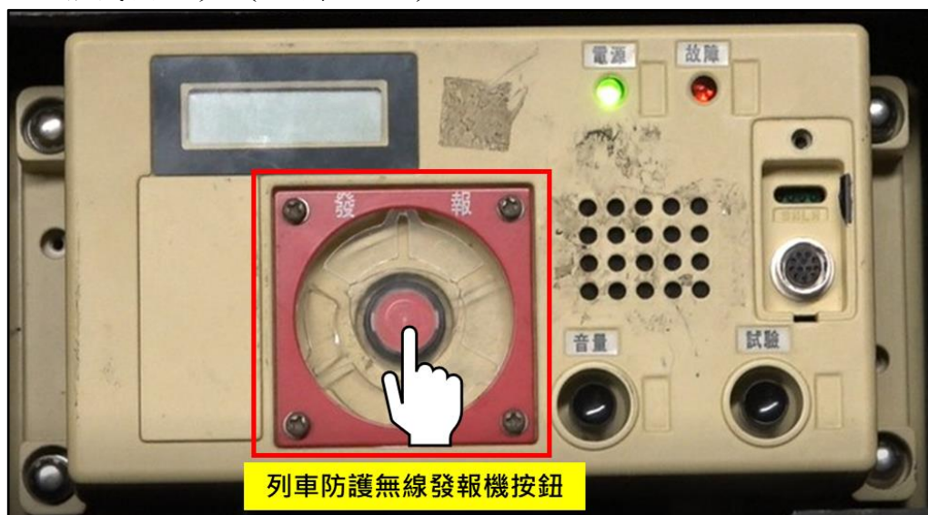
圖 1.8-5 列車防護無線發報機示意
