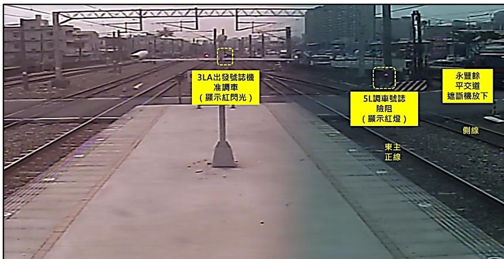
圖 1.13-4 0915:58 時成功站第一月台北端 CCTV 影像
