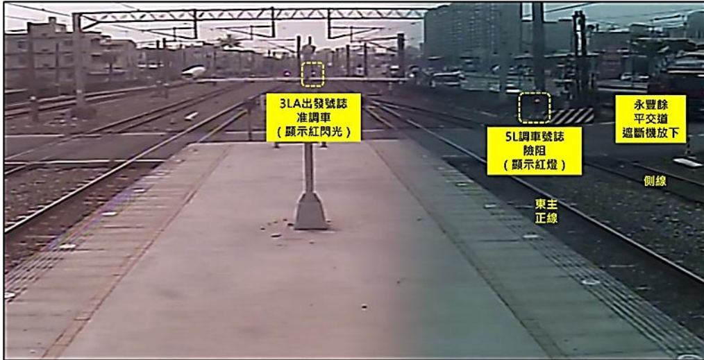
圖 1.13-2 0913:55 時成功站第一月台北端 CCTV 影像
