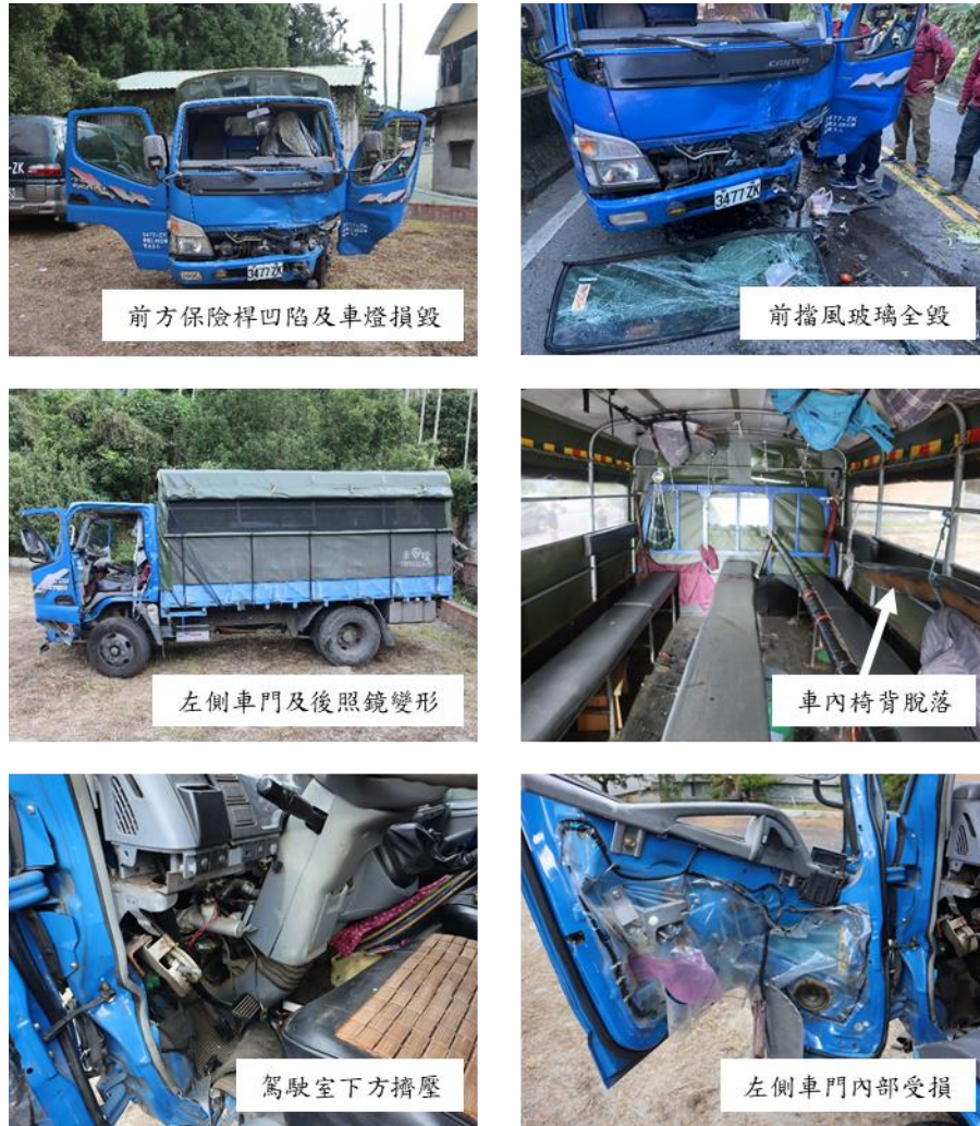
圖 1.3-1 車輛損害情形-A 車
