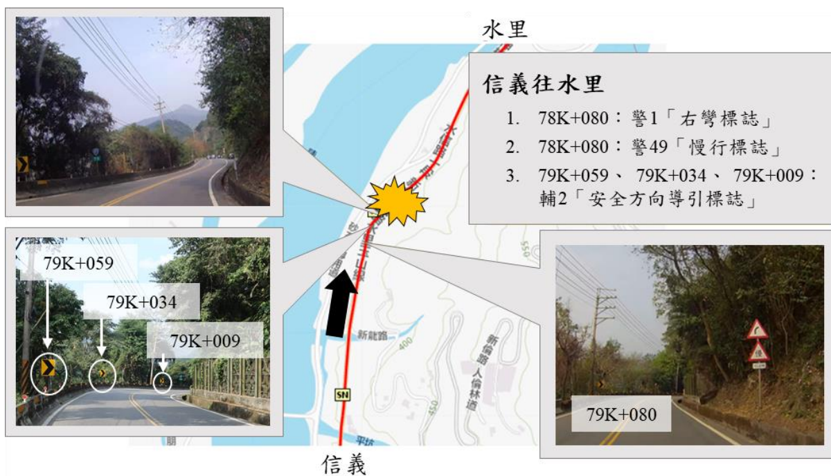
圖 1.8-4 事故地點附近往水里方向道路標誌設置位置
