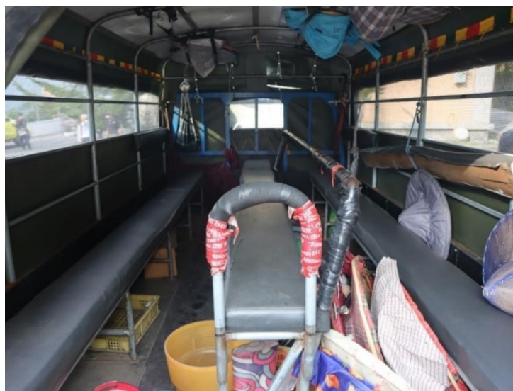
圖 1.12-1 後車廂改裝之座位配置
