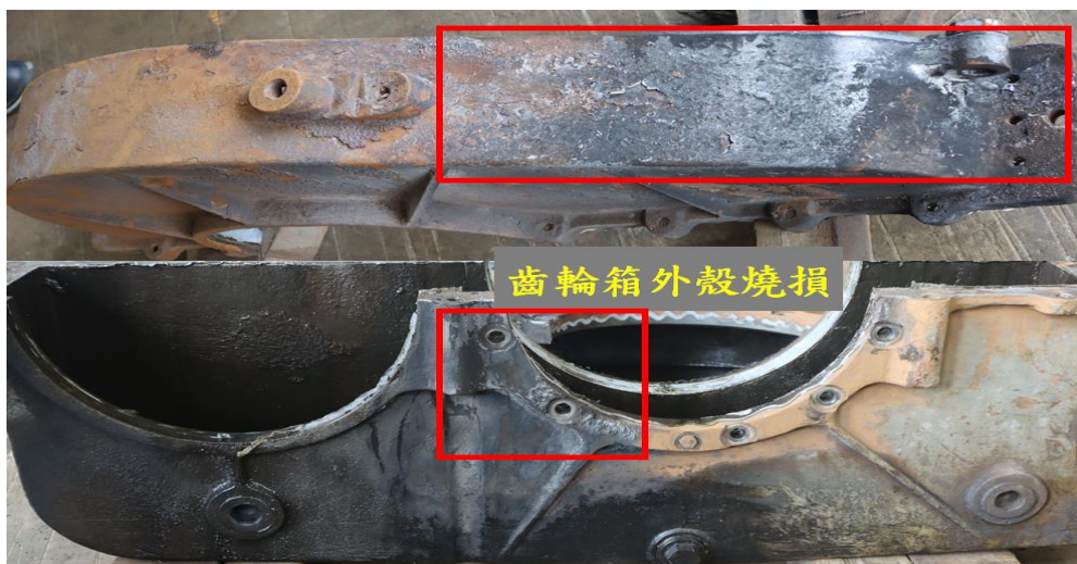
圖 1.2-5 第 2 轉向架第 1 車軸設備損害情形-4
