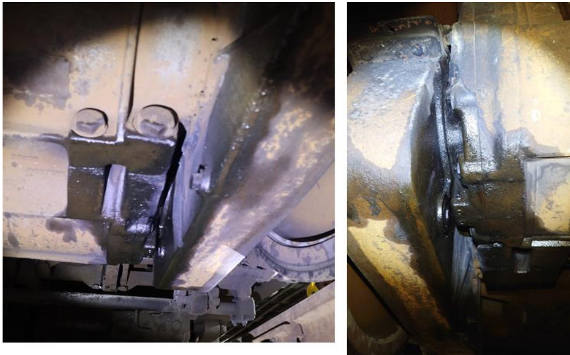
圖 1.8-1 EMC580 馬達及齒輪箱外殼油漬
