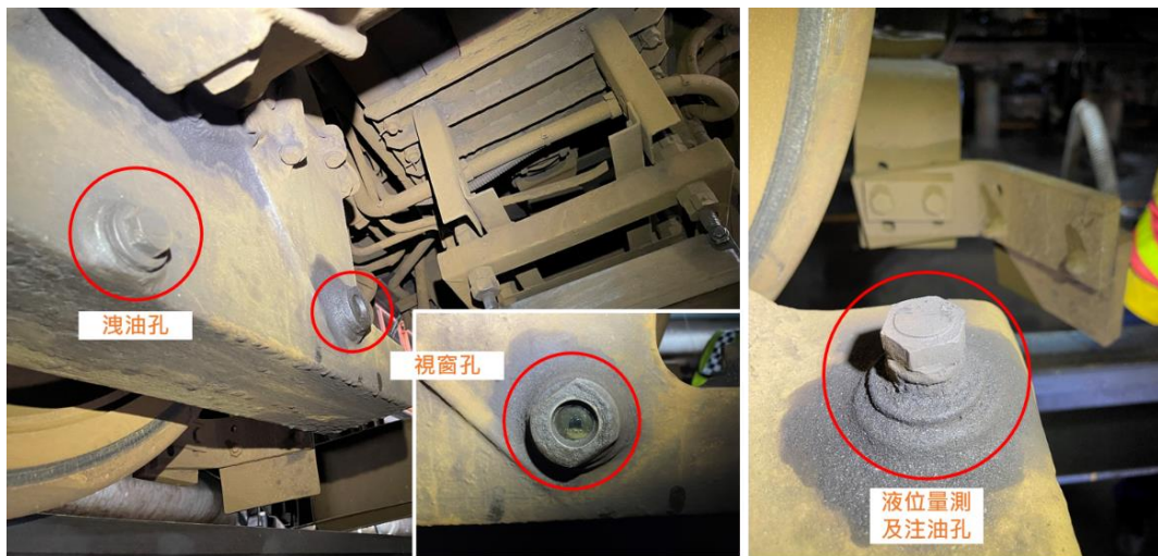
圖 1.7-7 馬達齒輪箱下部件孔位圖
