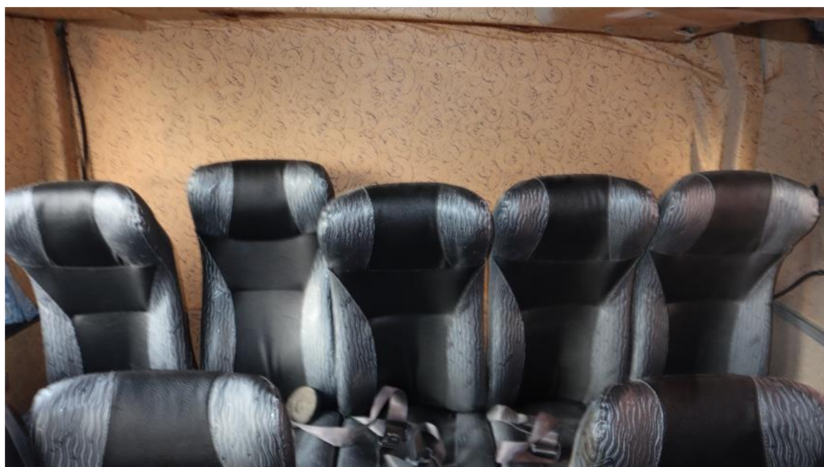
圖 1.12-1 事故車輛 6 排座椅前傾情形
