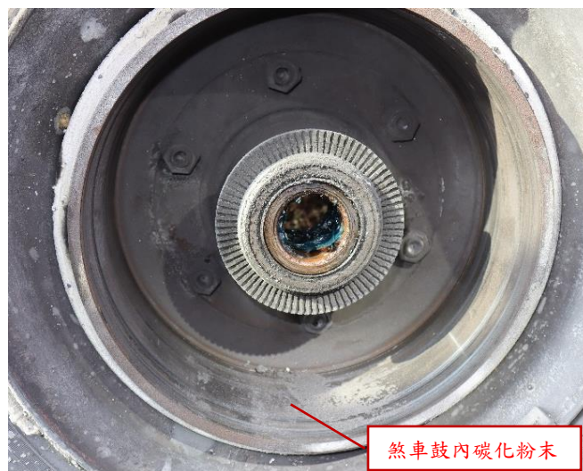
圖 1.3-7 事故車輛 4 輪煞車鼓及來令片
