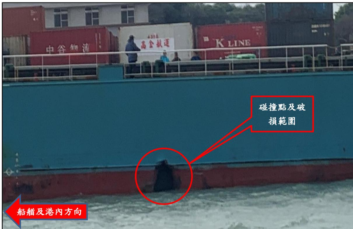
圖 3 大新左舷外殼遭撞破損圖
