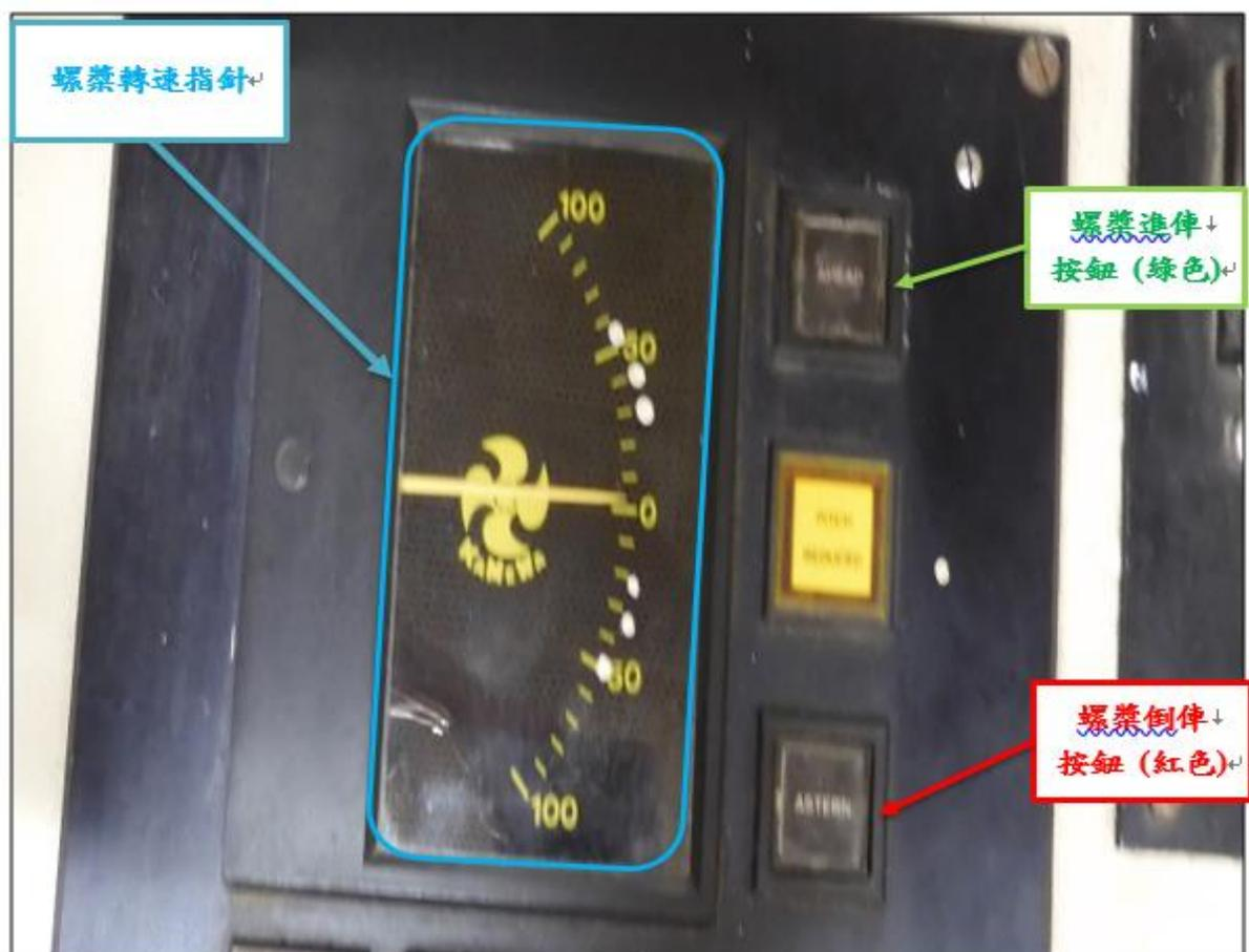
圖 7 機艙控制室操俾臺控制螺槳前後按鈕位置圖
