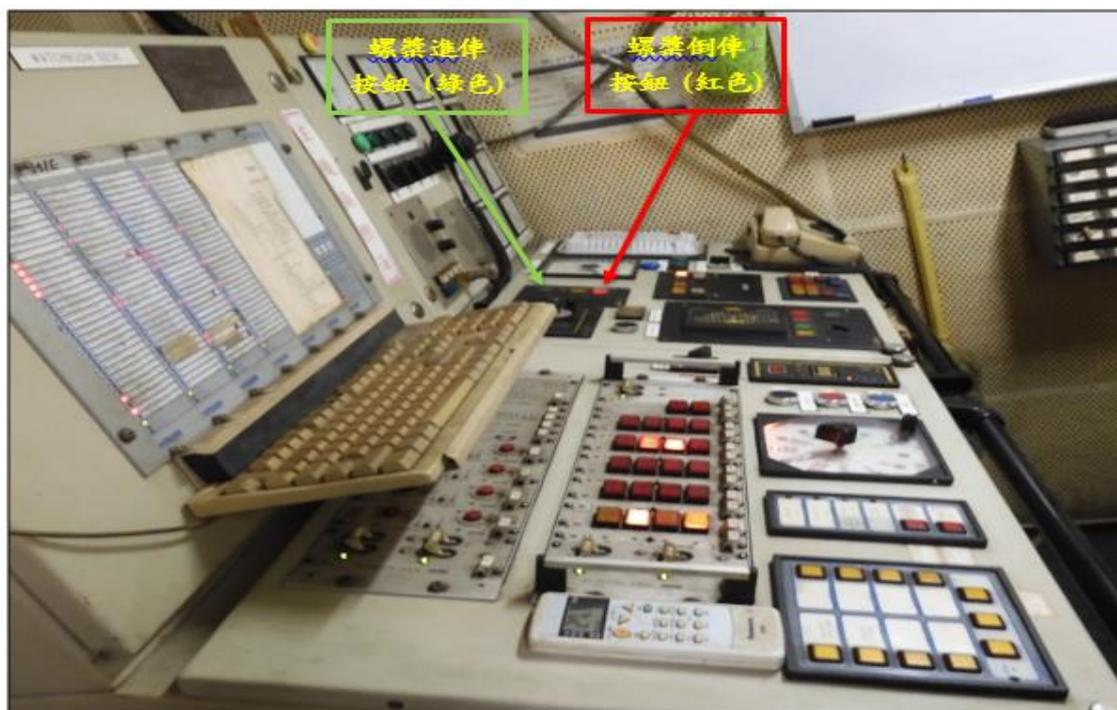
圖 6 機艙控制室操俾臺控制螺槳前後按鈕位置圖
