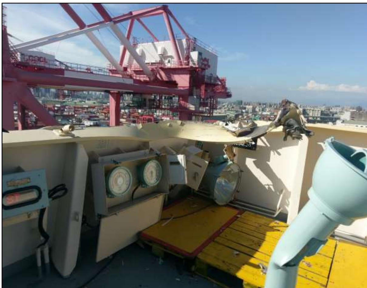
圖 3 東方德班駕駛臺右舷船橋損傷圖
