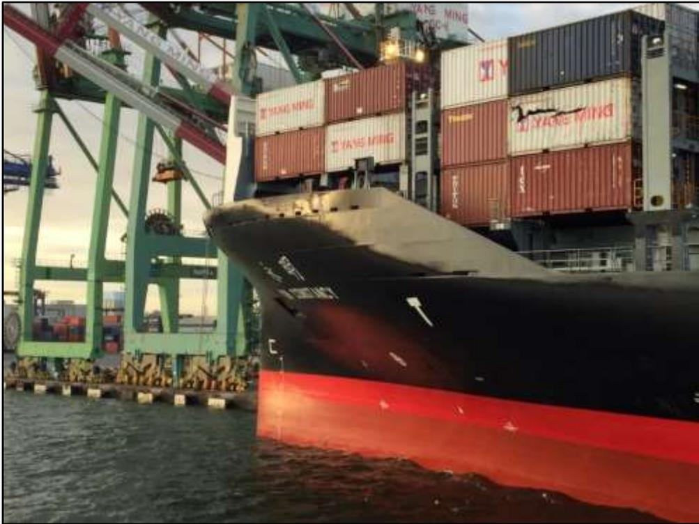
圖 4 永明左船艙船殼刮傷及貨櫃破損圖
