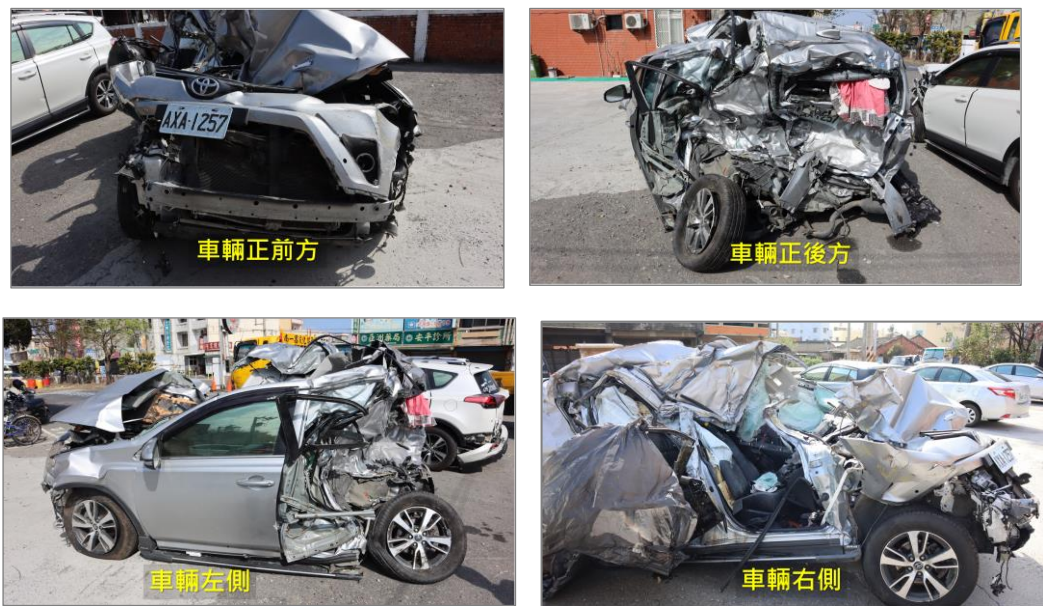
圖 7 事故車輛 B 損壞情形
