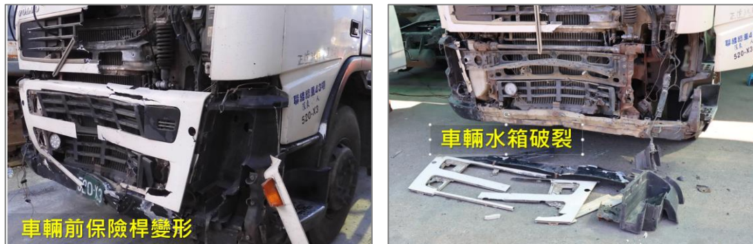
圖 10 事故車輛 U 損壞情形
