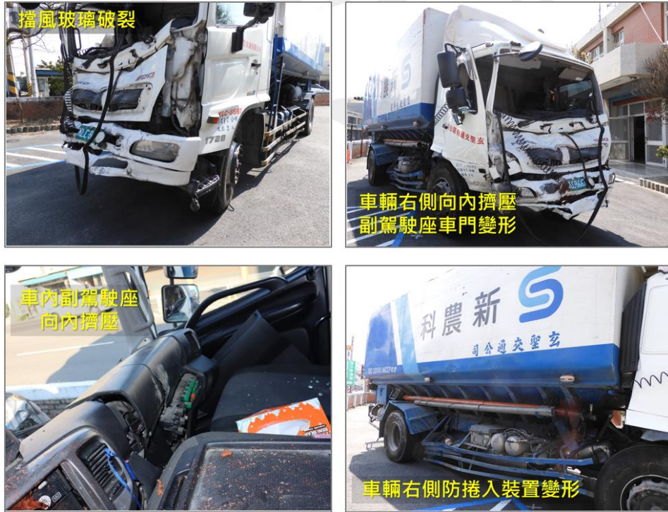
圖 8 事故車輛 F 損壞情形
