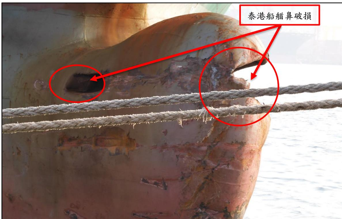
圖 2 泰港船艏鼻破損圖
