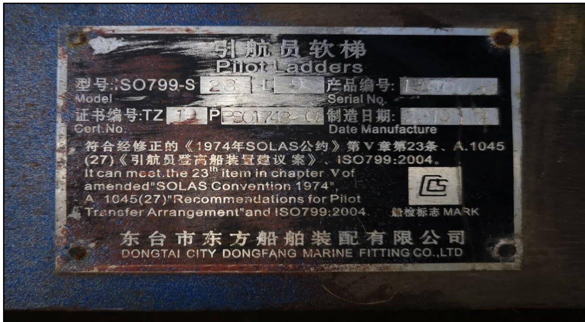
圖 1.7.1.1-2 曉洋輪右舷引水梯銘牌照片
