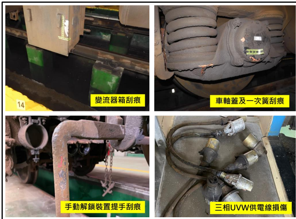
圖 1.3-6 事故列車第 3 車車廂損害照片
