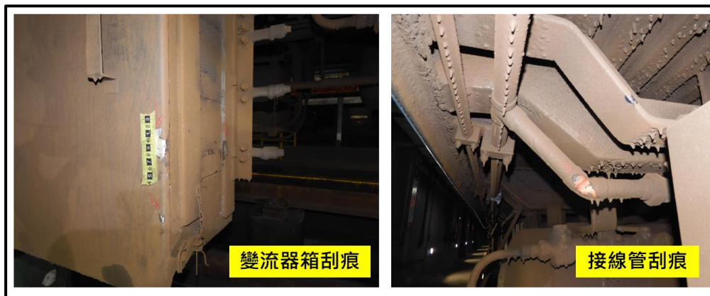
圖 1.3-8 事故列車第 4 車車廂損害照片
