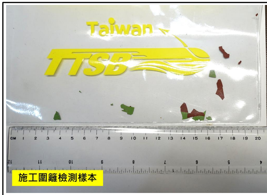
圖 1.14-1 施工圍籬漆料檢測樣本
