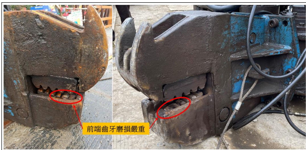
圖 1.6-7 夾頭齒排前端部份嚴重磨損
