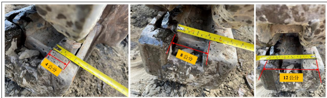
圖 1.6-6 打樁機夾頭尺寸圖（非事故現場）
