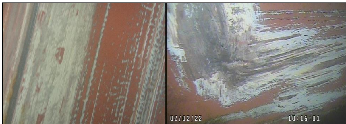
圖 6 5 號油艙近船底船殼處刮痕
