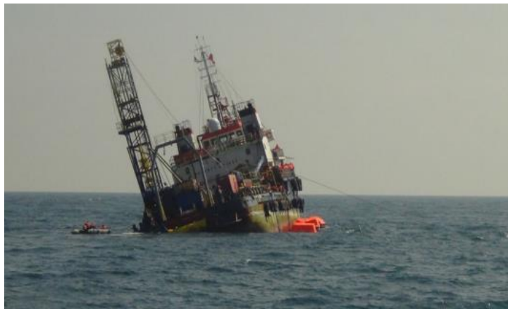
圖 2.2.2-16 工作船及鑽探設備傾斜狀況
