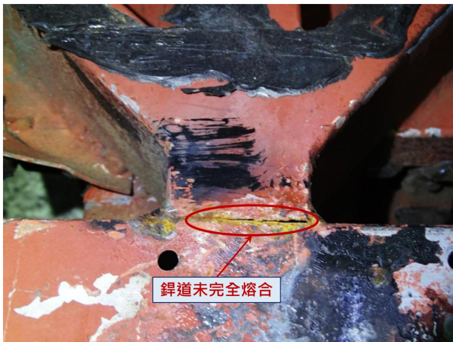
圖 1.13-10 右側骨架取樣 R6 呈現銲道熔合不完全現象
