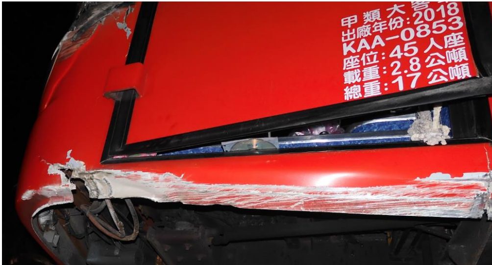
圖 2.3-5 事故車輛左前底盤呈現摩擦痕跡
