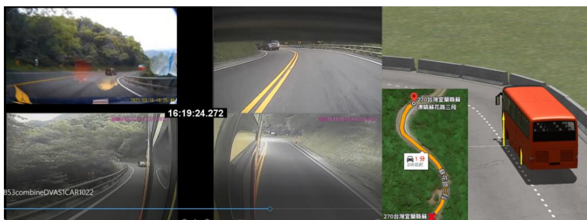
圖 2.3-1 進入左彎前壓道路中線
