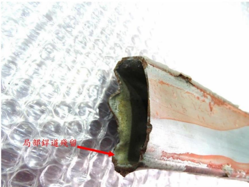
照片十八：左側骨架斷裂處 (No.L3-4) 有彎曲變形，斷裂面呈現快速破壞形貌，局部銲道殘留
