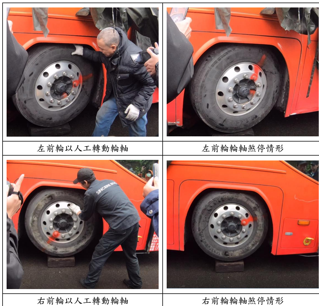
圖 1.3-10 事故車輛煞車測試作動情形
