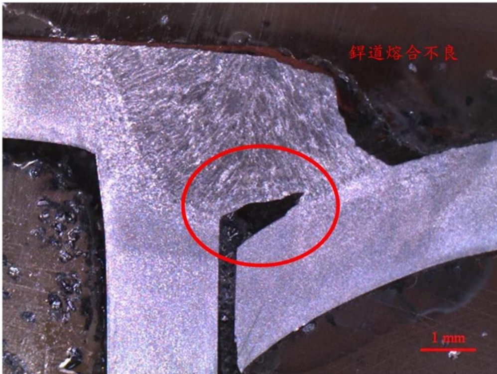
照片二十五：左側骨架未斷裂處 (No.L1) 銲接處銲道熔合不良
