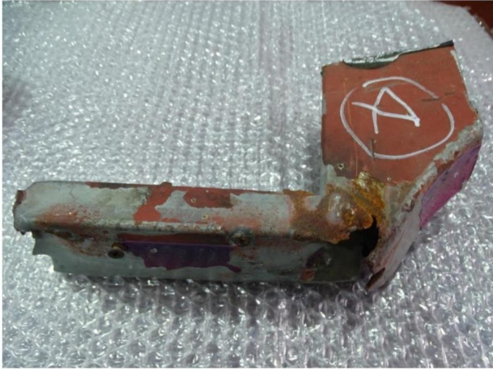
照片十七：左側骨架斷裂處 (No.L3-4) 有彎曲變形，斷裂面呈現快速破壞形貌
