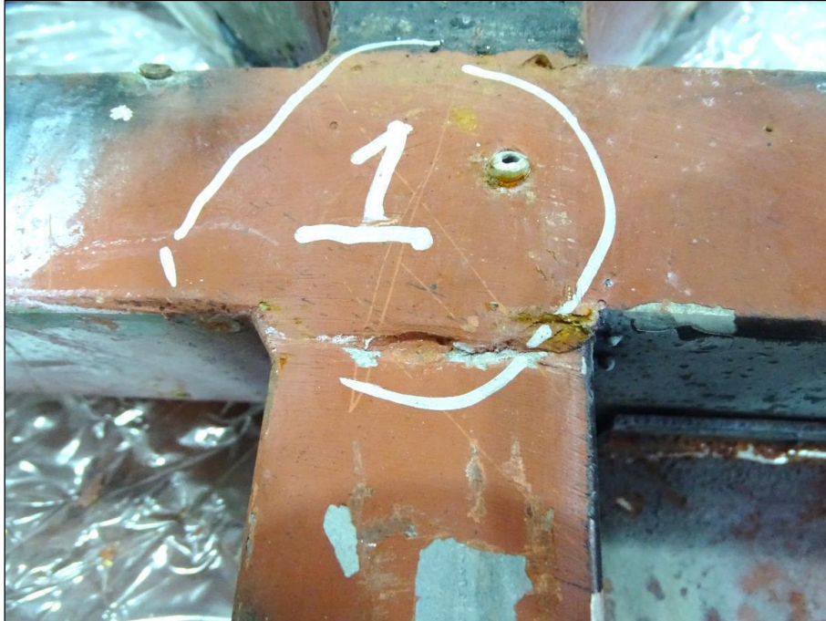
圖 1.13-6 左側骨架取樣 L1 呈現銲道未填滿瑕疵
