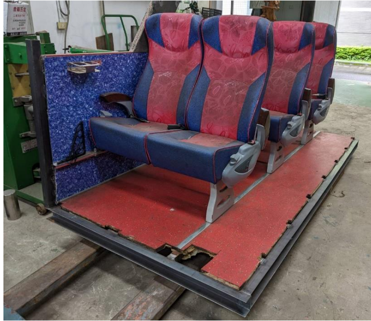
圖 1.13-18 經加固之測試座椅
