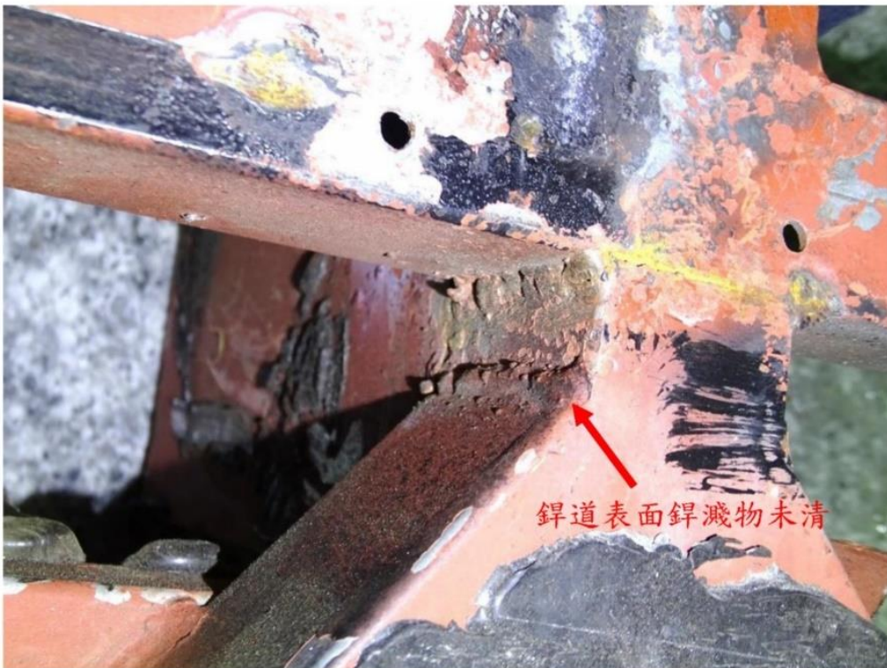
照片二十二：右側骨架未斷裂處 (No.R6) 鐸接處鐸道表面鐸濺物未清除
