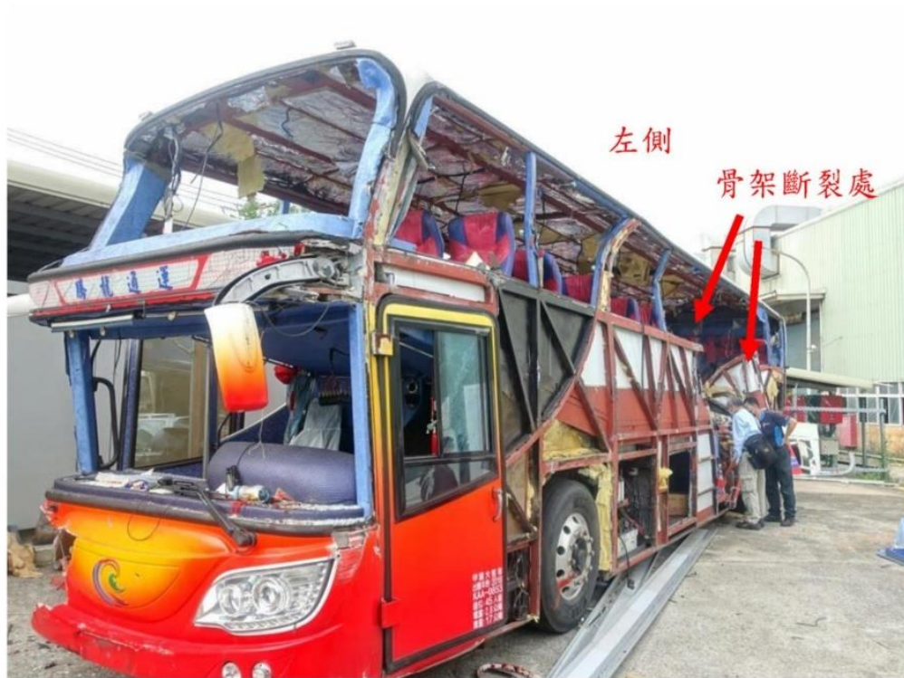
遊覽車損壞車體骨架左側
