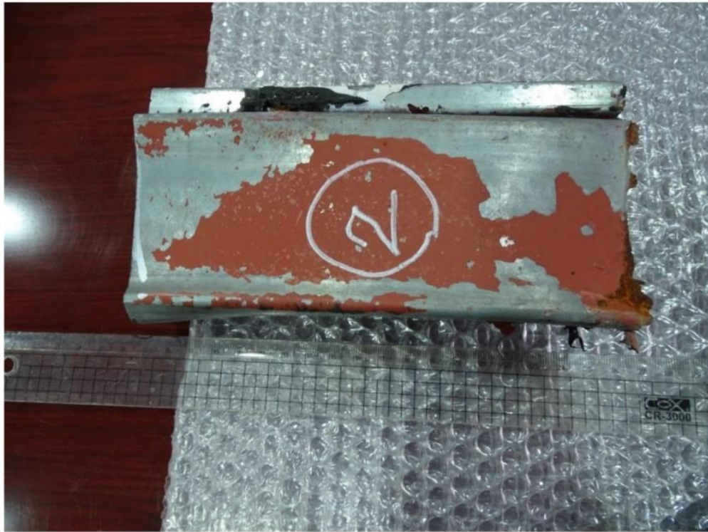
照片十三：左側骨架斷裂處 (No.L3-2) 有彎曲變形
