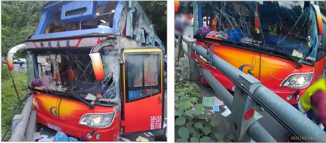
圖 1.3-15 事故車輛正面損壞情形
