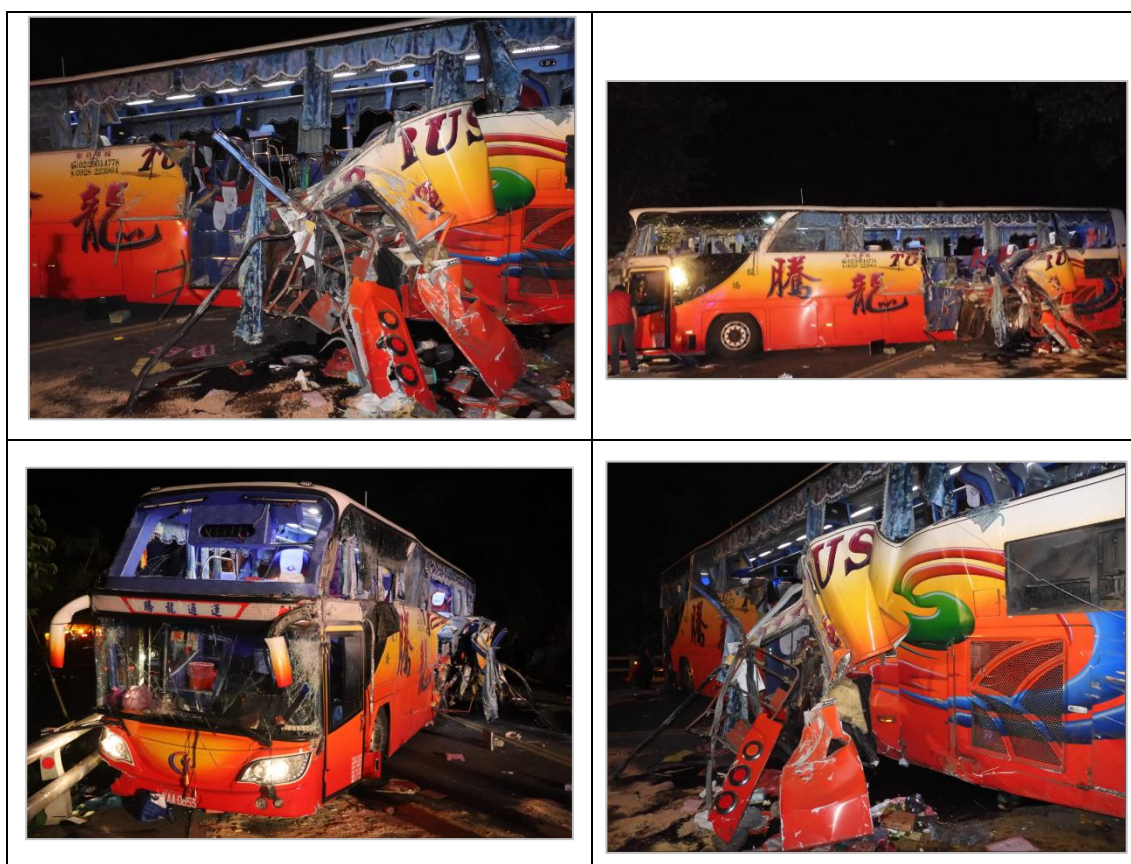
圖 1.12-2 事故車輛左側損壞狀況
