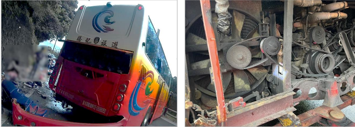
圖 1.3-18 事故車輛後方損壞情形
