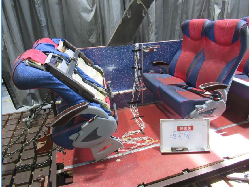
圖 1.13-21 靜態測試後之座椅固定裝置分離失效現象
