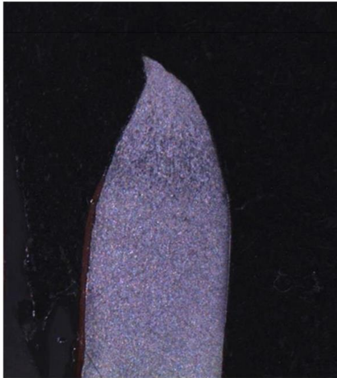
照片三十：左側骨架斷裂處 (No.L3) 銲接處銲道呈現撕裂狀快速破壞形貌
