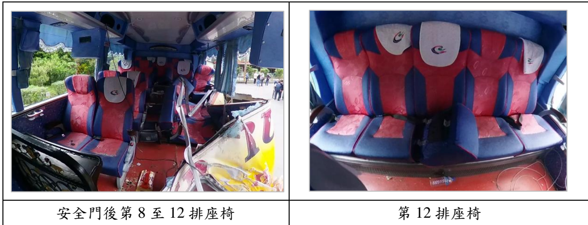
圖 1.12-3 事故車輛內部座椅狀況
