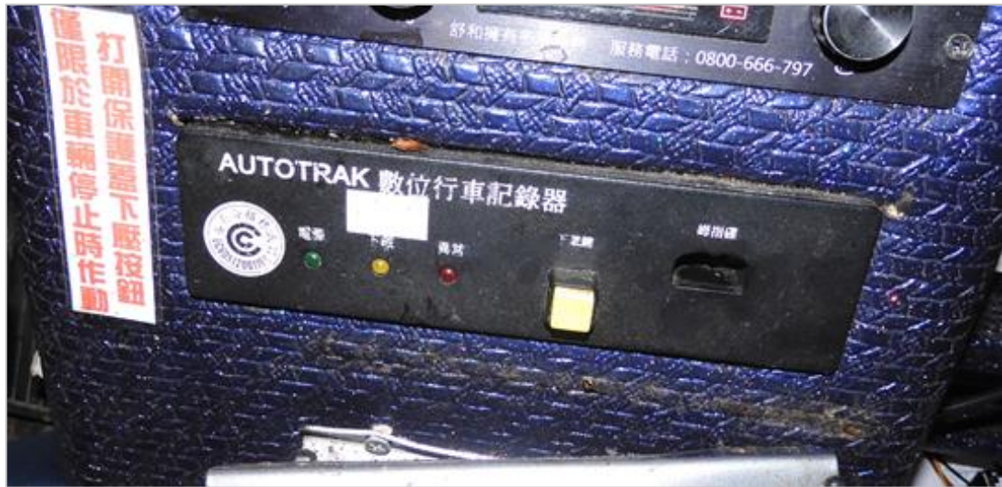
圖 1.9-1 事故車輛安裝之行車紀錄器
