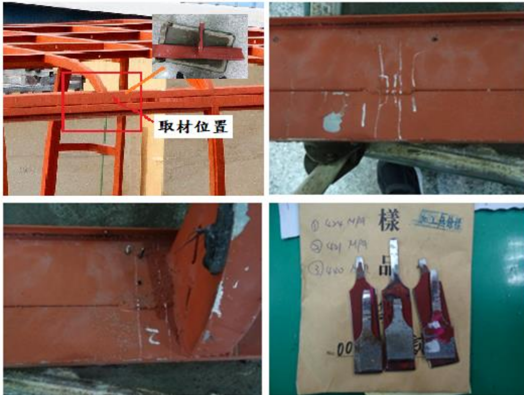
圖 1.13-12 銲道正常之骨架試片以及拉伸試驗
