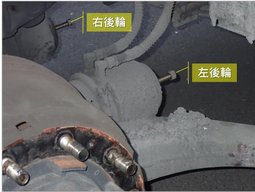
圖 1.3-6 手煞車系統固定螺絲釋放狀況
