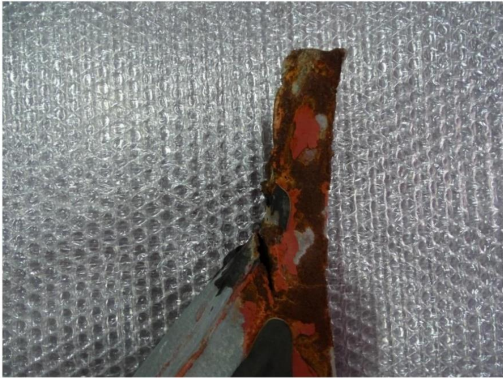
照片十五：左側骨架斷裂處 (No.L3-3) 有彎曲變形，斷裂面呈現快速破壞形貌
