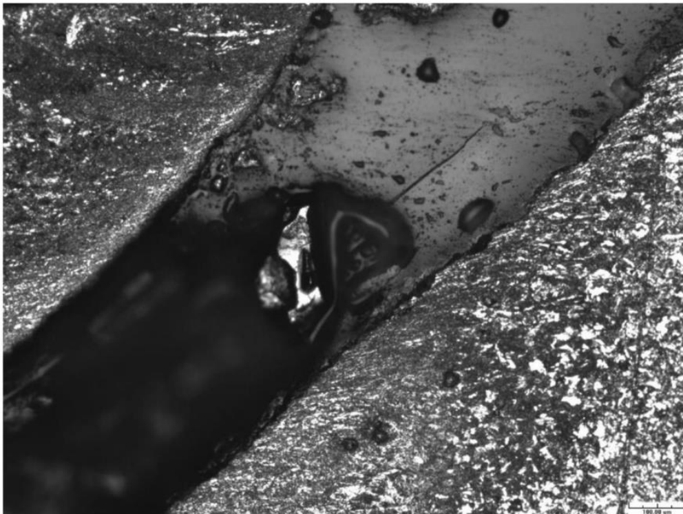
照片四十三：右側骨架看似未斷裂處 (No.R6) 鐸道呈現快速破壞形貌，倍率 100X
