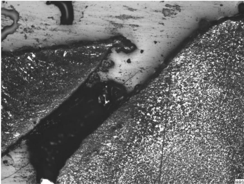
照片四十二：右側骨架看似未斷裂處 (No.R6) 鐸道呈現快速破壞形貌，倍率 50X
