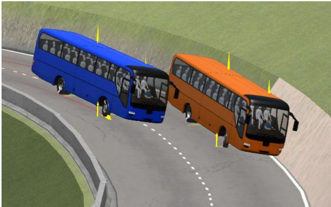
圖 2.3-12 事故車輛有無安裝 VSF 之動態模擬比較 58
