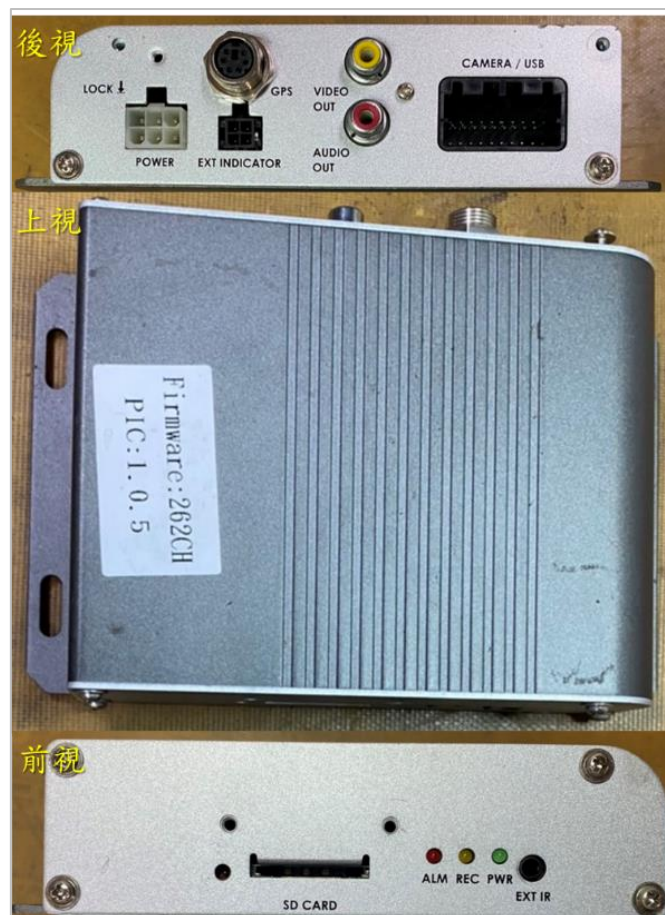
圖 1.9-7 車威視行車視野輔助系統外觀
