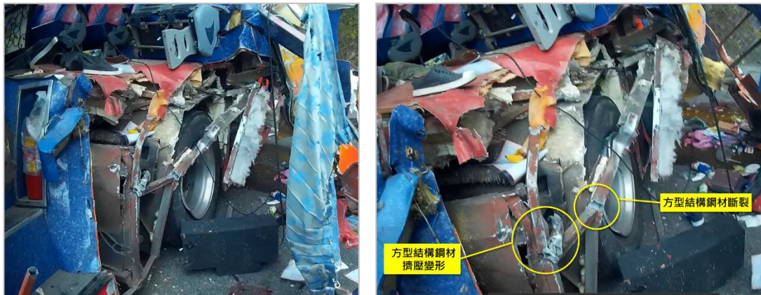
圖 1.3-21 事故車輛左側安全門至第 9 排座椅損壞情形
