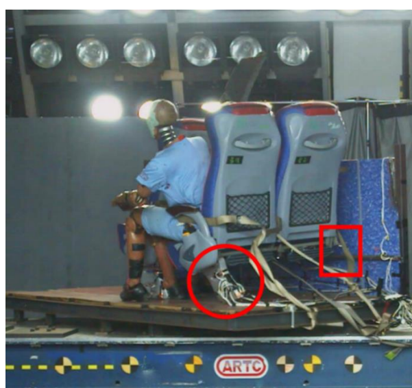
圖 1.13-24 座椅動態測試過程，後排座椅靠走道側椅腳脫離地板（紅圈處），及靠窗側 J 形勾脫離固定處（紅框處）之瞬間
