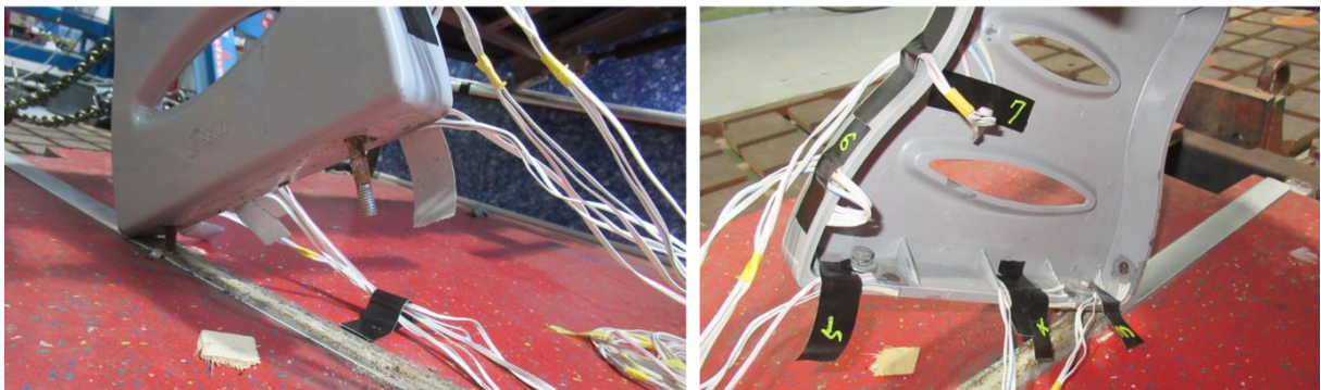
圖 1.13-22(b) 測試後靠走道側固定裝置
