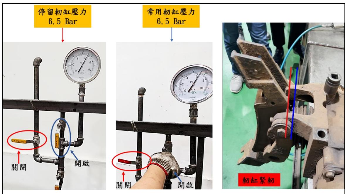
圖 1.11-4 常用軔缸緊軔（閘瓦托架向前至紅線）
