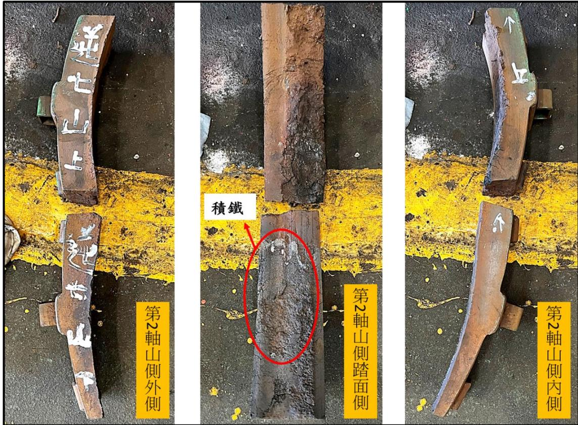
圖 1.2-4 事故轉向架第 2 軸山側閘瓦有積鐵
