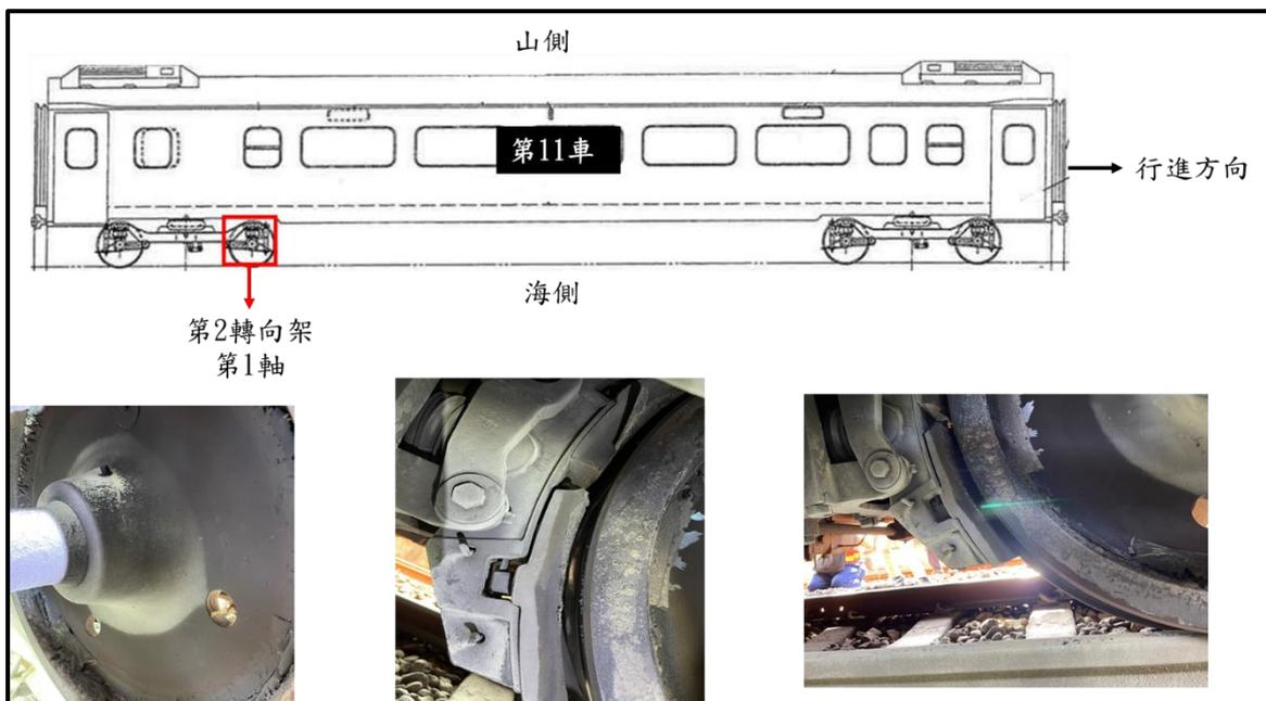
圖 1.2-1 事故轉向架第 1 軸海側車輪燒灼痕跡
