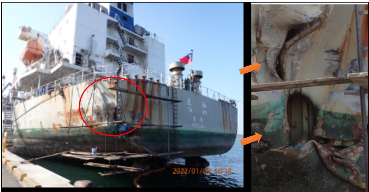
圖 2 達和輪左船艉受損現場照片
