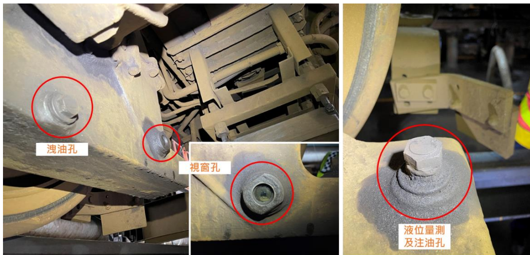
圖 1.7-7 馬達齒輪箱下部件孔位圖
