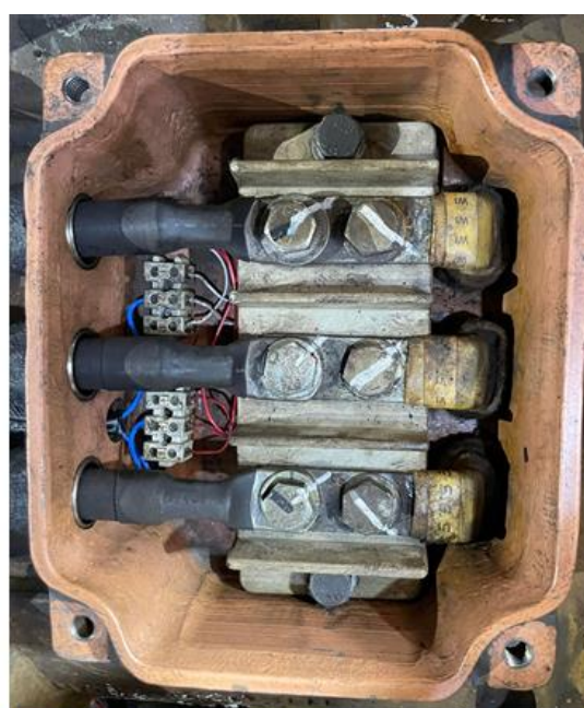
圖 2.2-3 事故列車牽引馬達端子盒內溫度感測器
