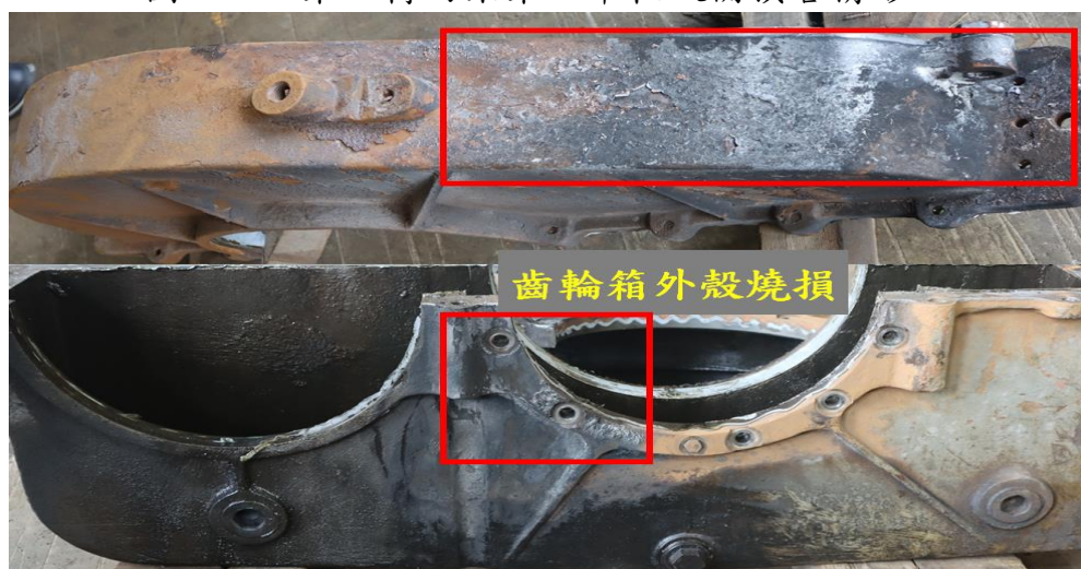
圖 1.2-5 第 2 轉向架第 1 車軸設備損害情形-4
