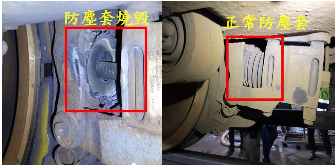
圖 1.2-3 第 2 轉向架第 1 車軸設備損害情形-2
