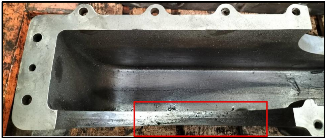
圖 2.3-1 齒輪箱接合面髒汙（非事故車）
