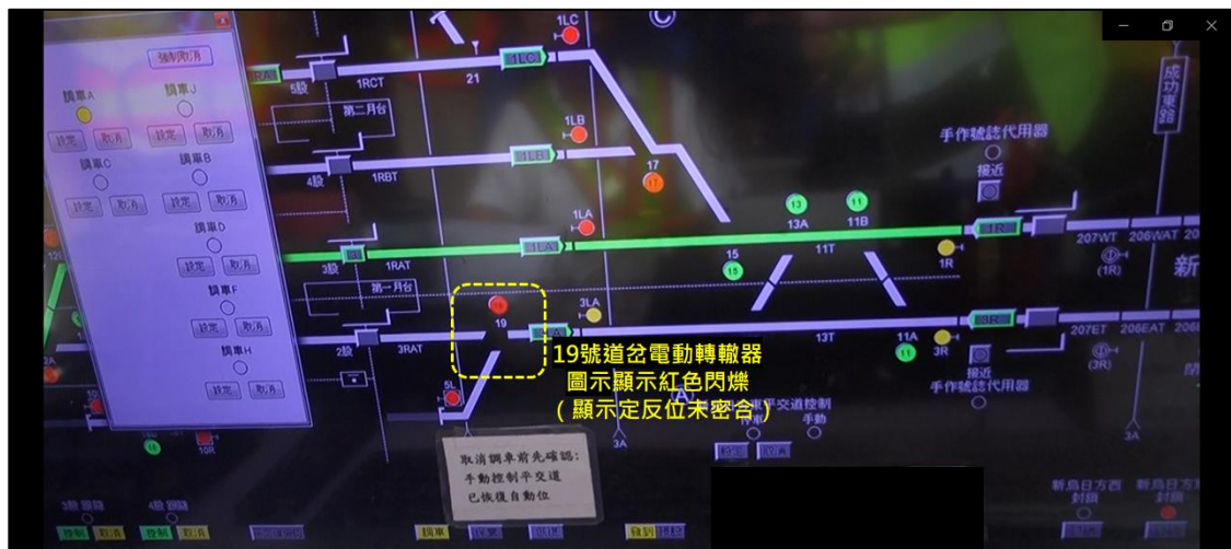
圖 1.15-2 轉轍器告警測試_1 (5 公厘厚鐵片)
