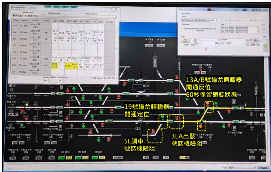
圖 1.9-12 0931:39 時成功站號誌運轉紀錄器狀態
