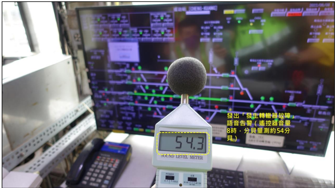
圖 1.15-6 轉轍器告警測試_5 (5 公厘厚鐵片)
