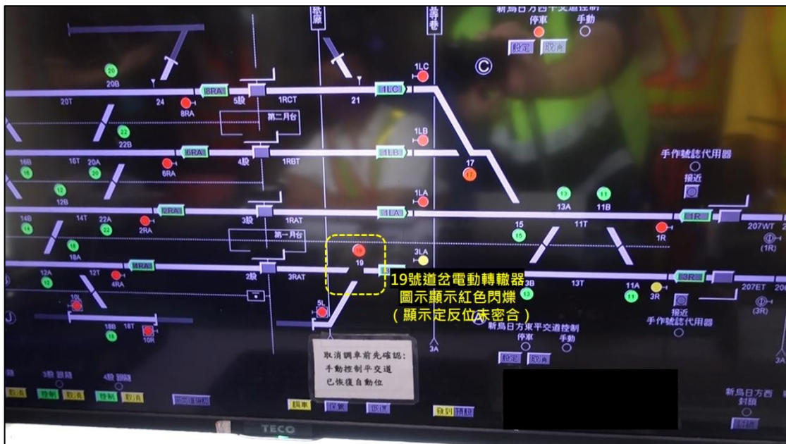
圖 1.15-8 列車擠岔後停車轉轍器告警測試_1
