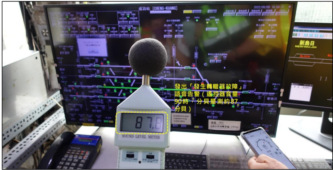
圖 1.15-5 轉轍器告警測試_4 (5 公厘厚鐵片)
