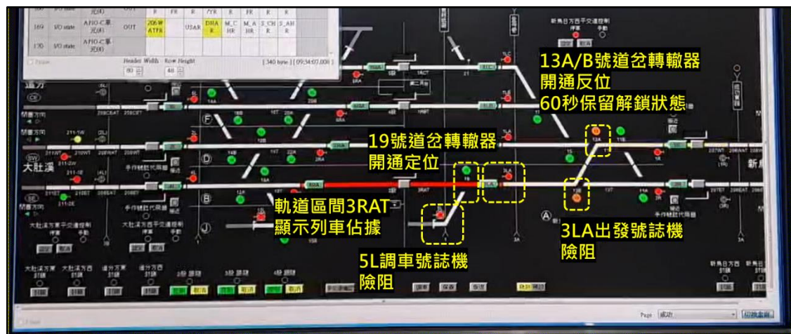
圖 1.9-14 0932:39 時成功站號誌運轉紀錄器狀態
