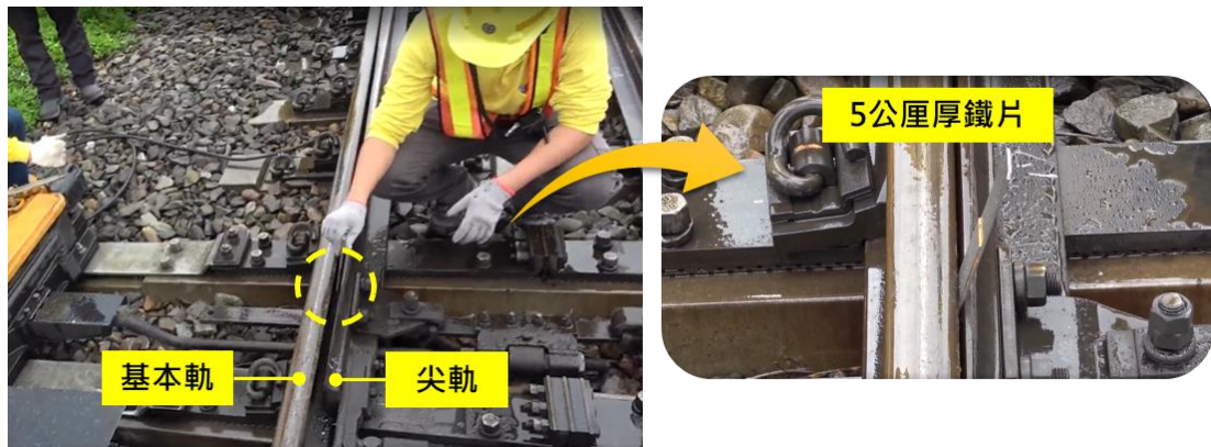
圖 1.15-1 現場轉轍器告警功能測試位置
