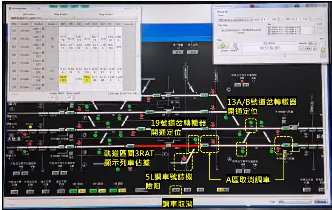
圖 1.9-16 0936:10 時成功站號誌運轉紀錄器狀態
