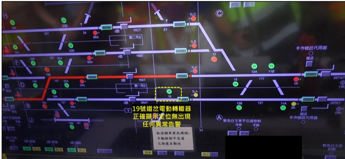
圖 1.15-7 轉轍器告警測試 (3 公厘厚鐵片)
