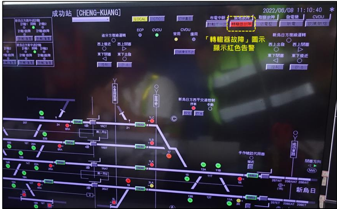
圖 1.15-9 列車擠岔後停車轉轍器告警測試_2
