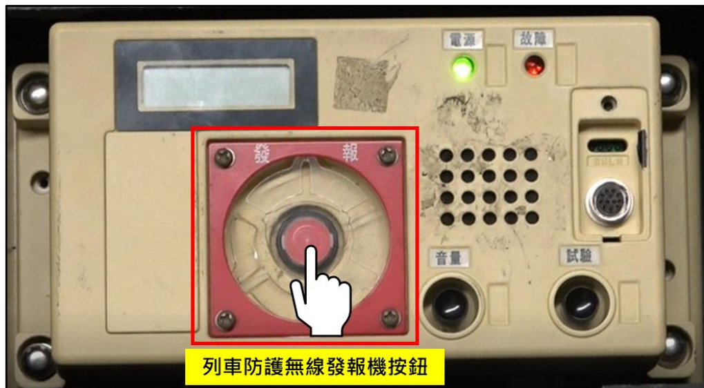
圖 1.8-5 列車防護無線發報機示意
