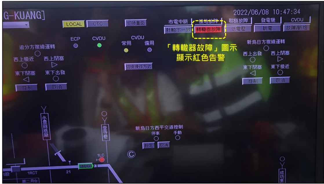
圖 1.15-3 轉轍器告警測試_2 (5 公厘厚鐵片)
