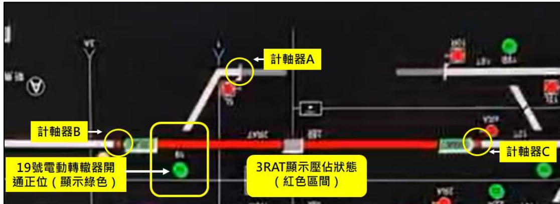
圖 1.9-9 軌道區間 3RAT 壓佔狀態示意圖
