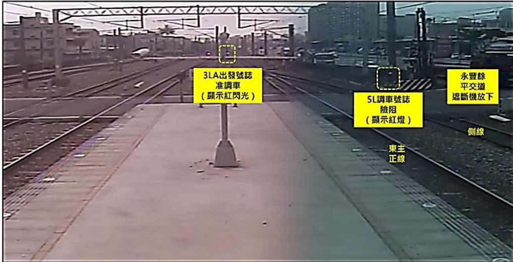
圖 1.13-2 0913:55 時成功站第一月台北端 CCTV 影像
