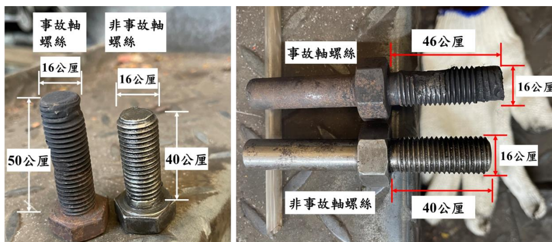
圖 1.7-4 事故軸螺絲與非事故軸螺絲比較
