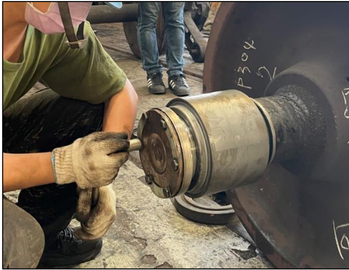
圖 1.11-7 外包維修人員鎖車軸外蓋
