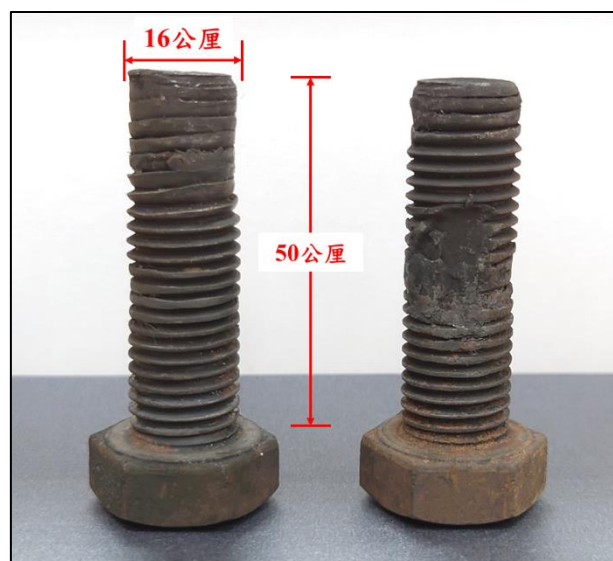
圖 1.3-7 螺絲損害情形及尺寸
