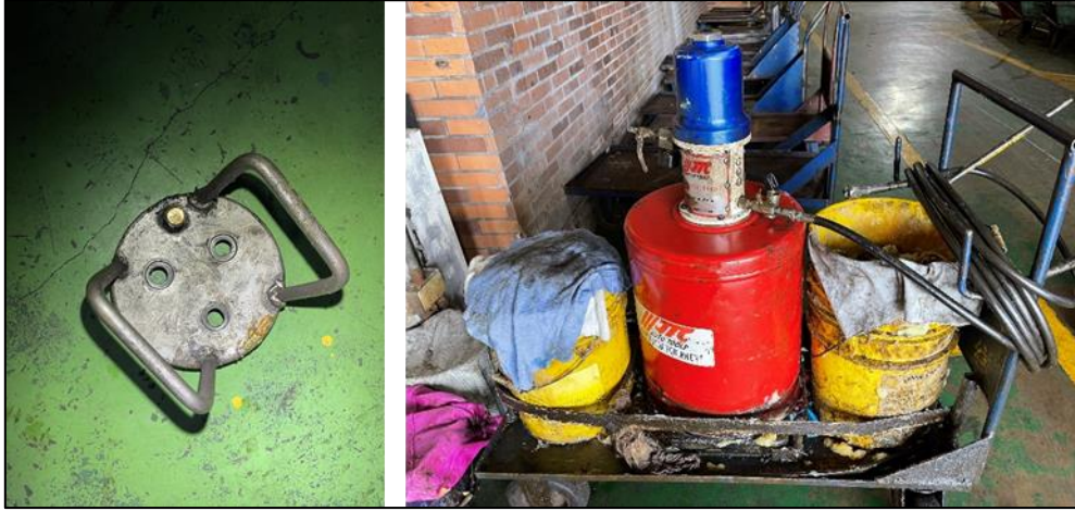
圖 1.11-8 加脂用軸端蓋（左）及氣動黃油機（右）
