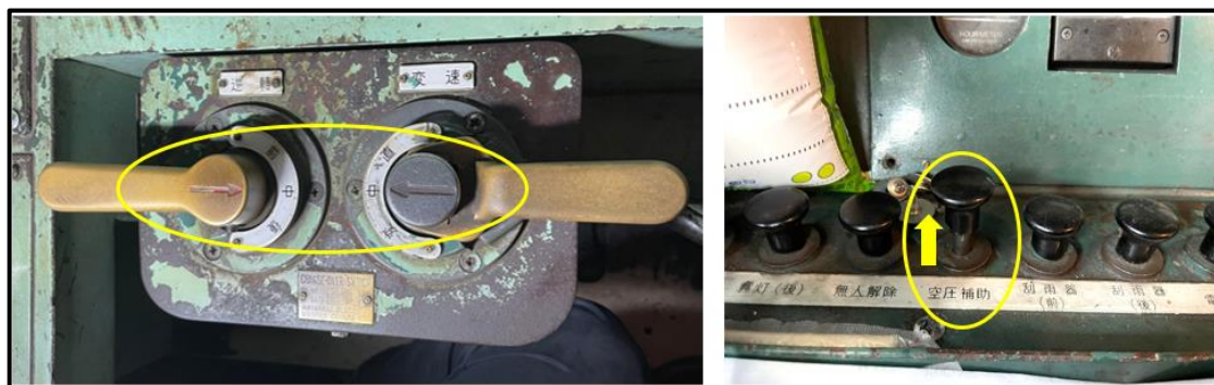
圖 1.15-3 啟動 Type C3000 型空氣壓縮機快速充氣之方式
