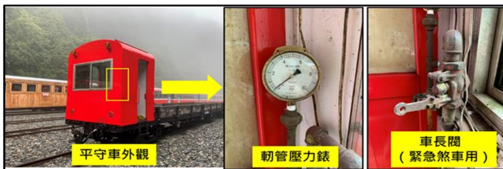
圖 1.8-1 平守車外觀、壓力錶及車長閥
