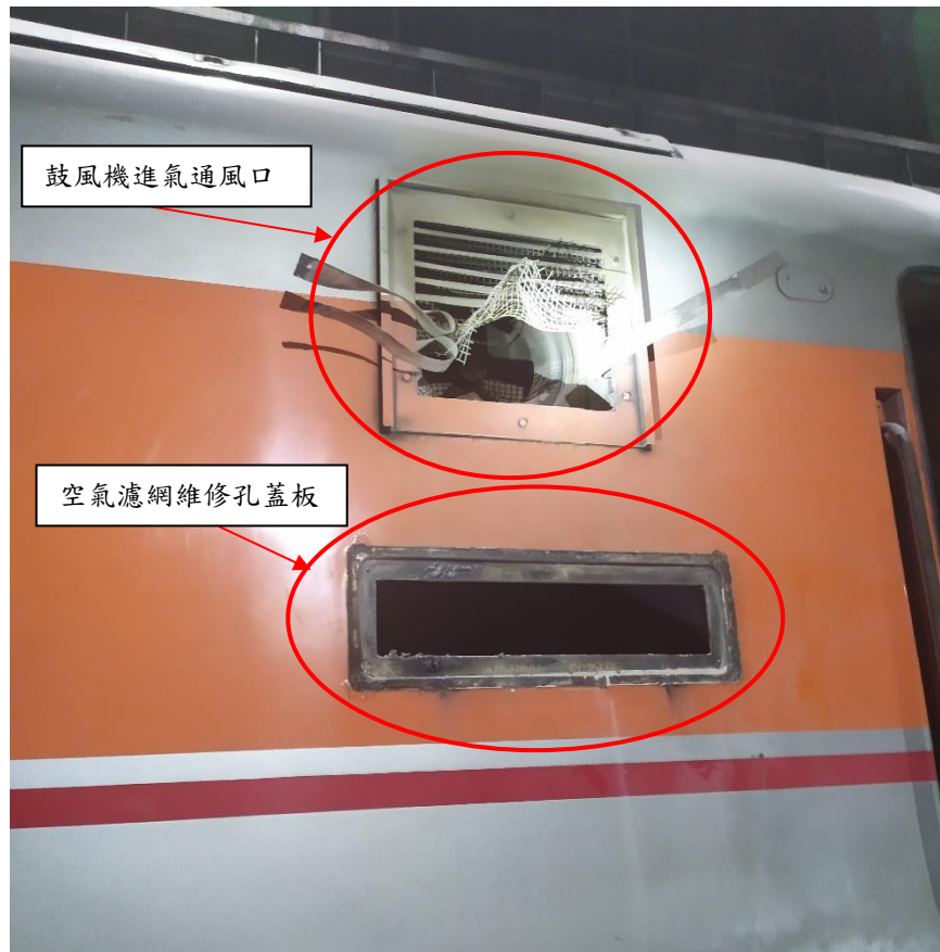
圖 1.1-2 「鼓風機進氣通風口」及「空氣濾網維修孔蓋板」 (非事故當時拍攝)
