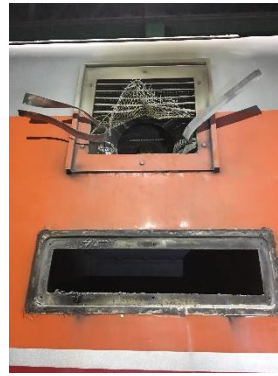
冷卻空氣進氣口（上方） 空氣濾網置放處（下方）
