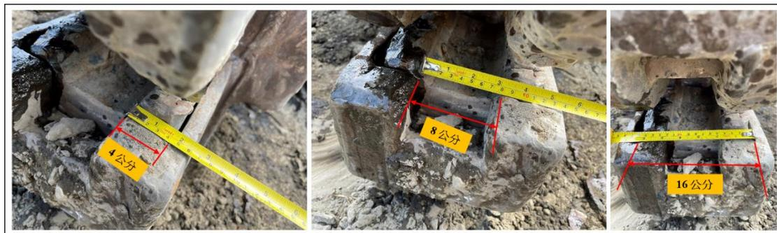
圖 1.5-6 打樁機夾頭尺寸圖（非於事故現場量測）
