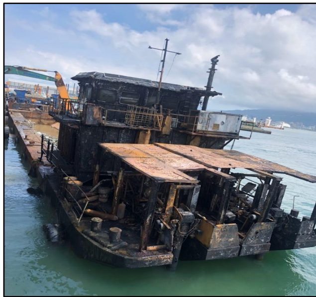
圖 4 昭伸二號船艙失火後外觀及橫倒之氣體鋼瓶
