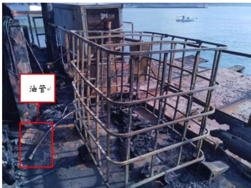
圖 8 駕駛室後方燃油容器鋼質框架
