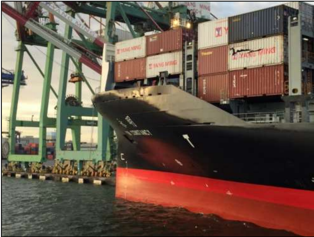
圖 4 永明左船艙船殼刮傷及貨櫃破損圖
