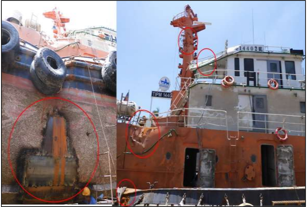
圖 2 拖船 14402 船體損害圖
