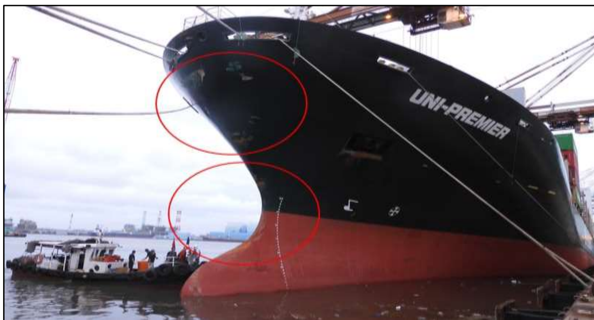
圖 1 立揆船艙左舷損害圖
