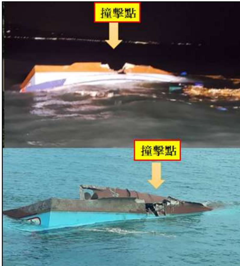
圖 4 茂凱 8 號船體損害現場照片 (上：茂凱 8 號船東提供、下：海巡署資料)
