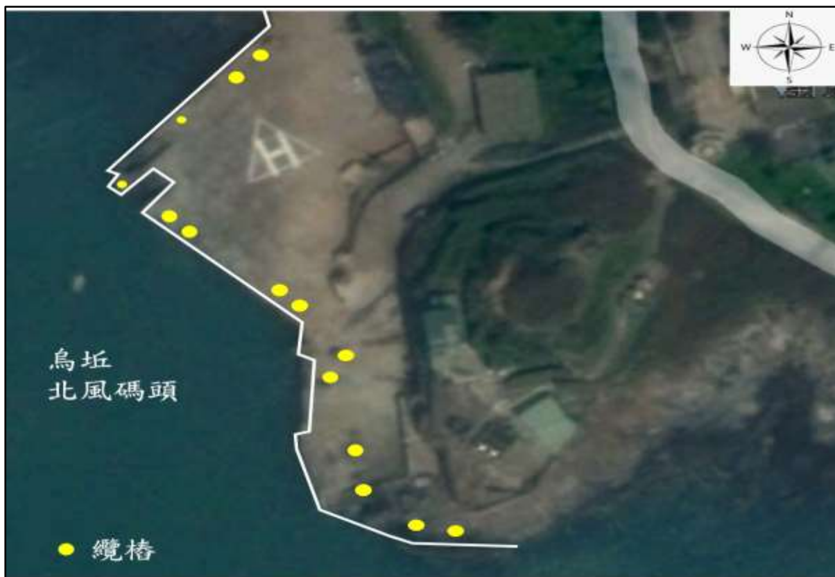
圖 5 烏坵北風碼頭及其纜樁示意圖
