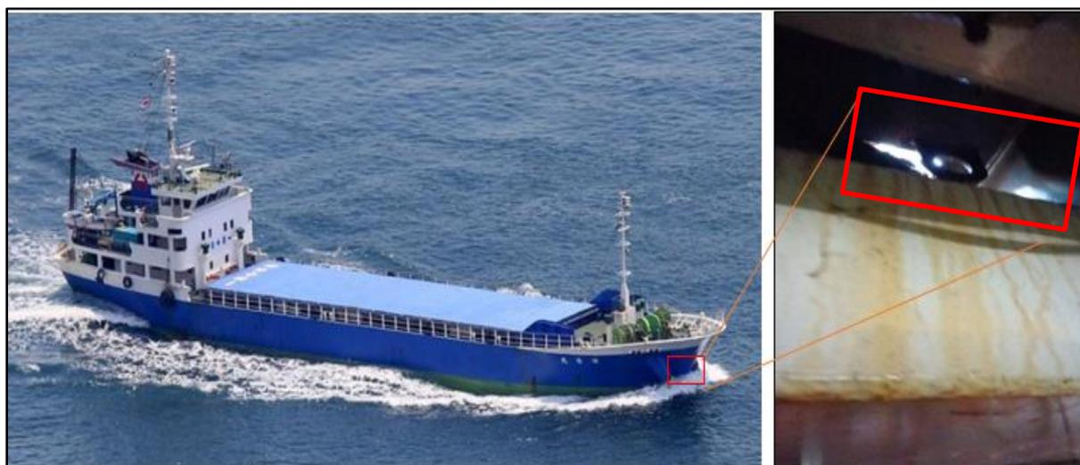
圖 7 船長發送給萬順船舶公司之幸運輪受損照片(右)
