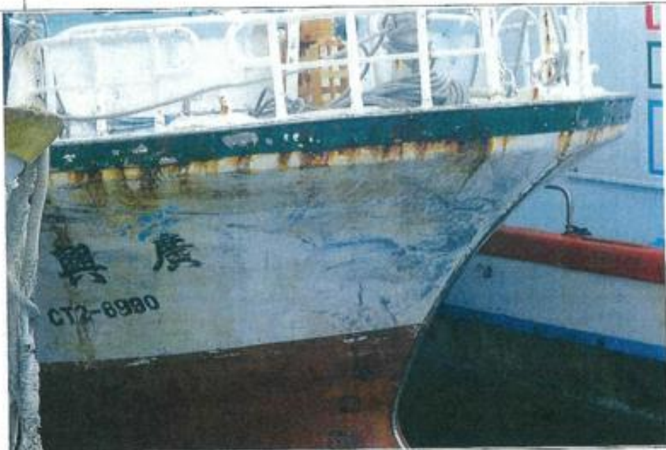
說明 「廣興滿號 CT2-6990」漁船船艙右舷碰撞痕跡。
