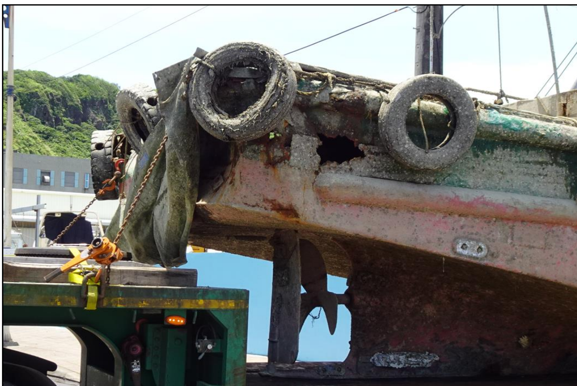
圖 29 東洋 6 號右船艙船殼破損處 (約 20 公分 X 15 公分)
