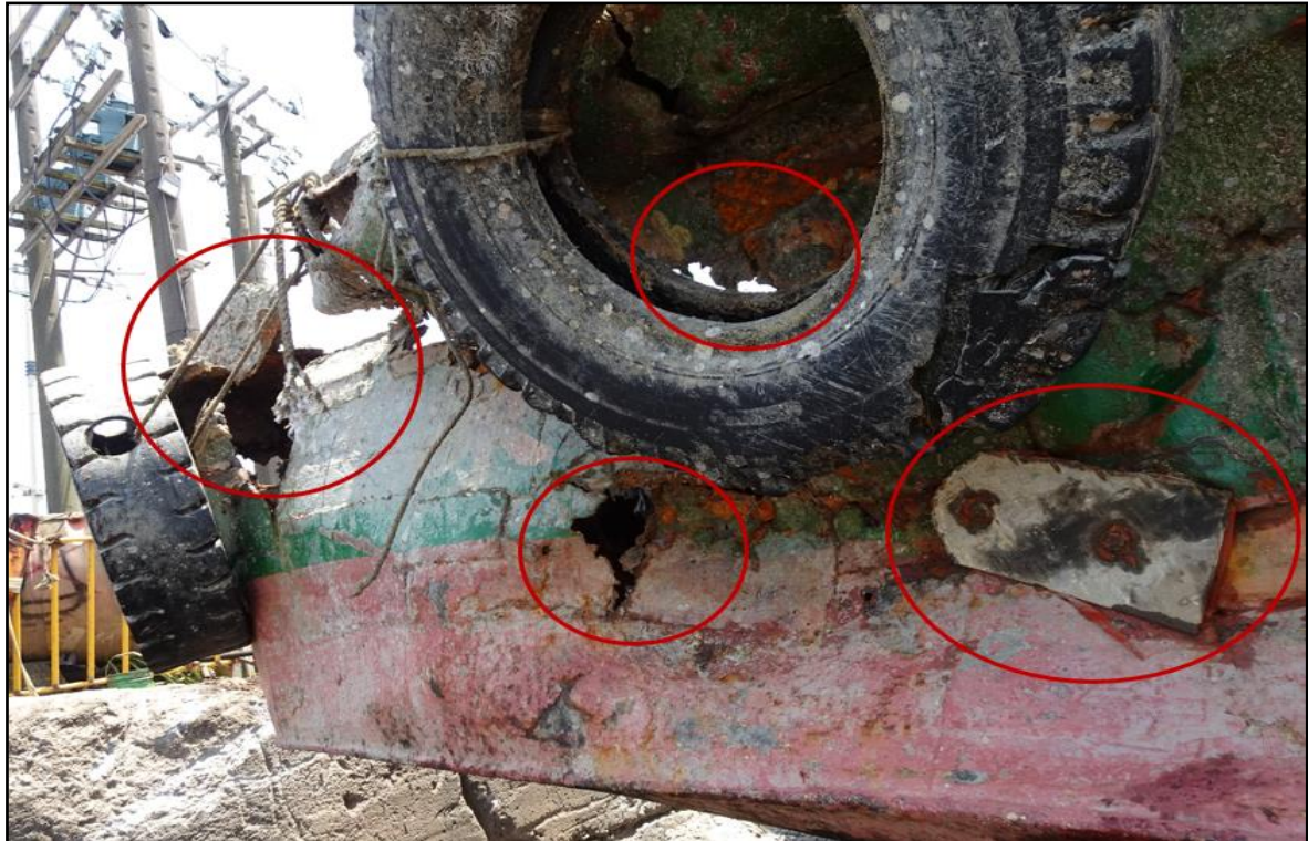
圖 19 東洋 6 號左船艙修補及破損處
