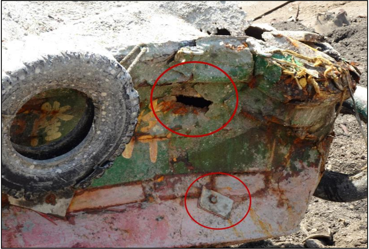
圖 20 東洋 6 號船艙修補及破損處
