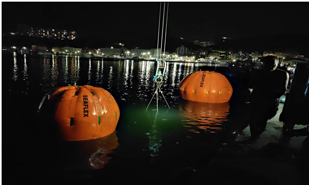
圖 4 使用充氣浮球將東洋 6 號浮上海面吊掛
