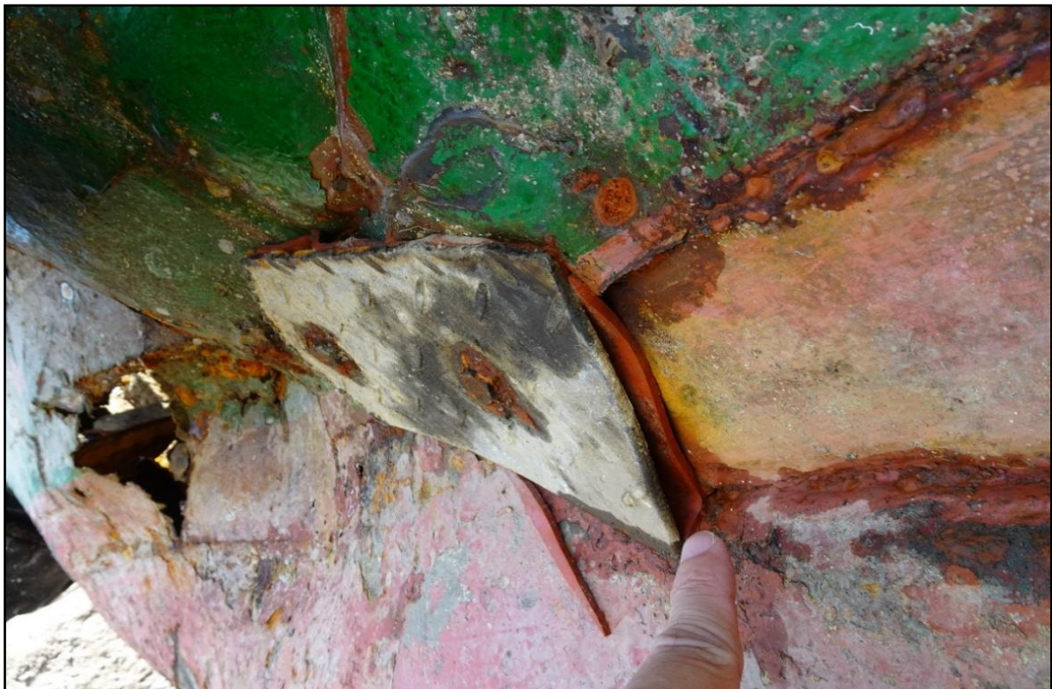
圖 23 東洋 6 號船艙使用夾板、墊片及螺桿修理處之一
