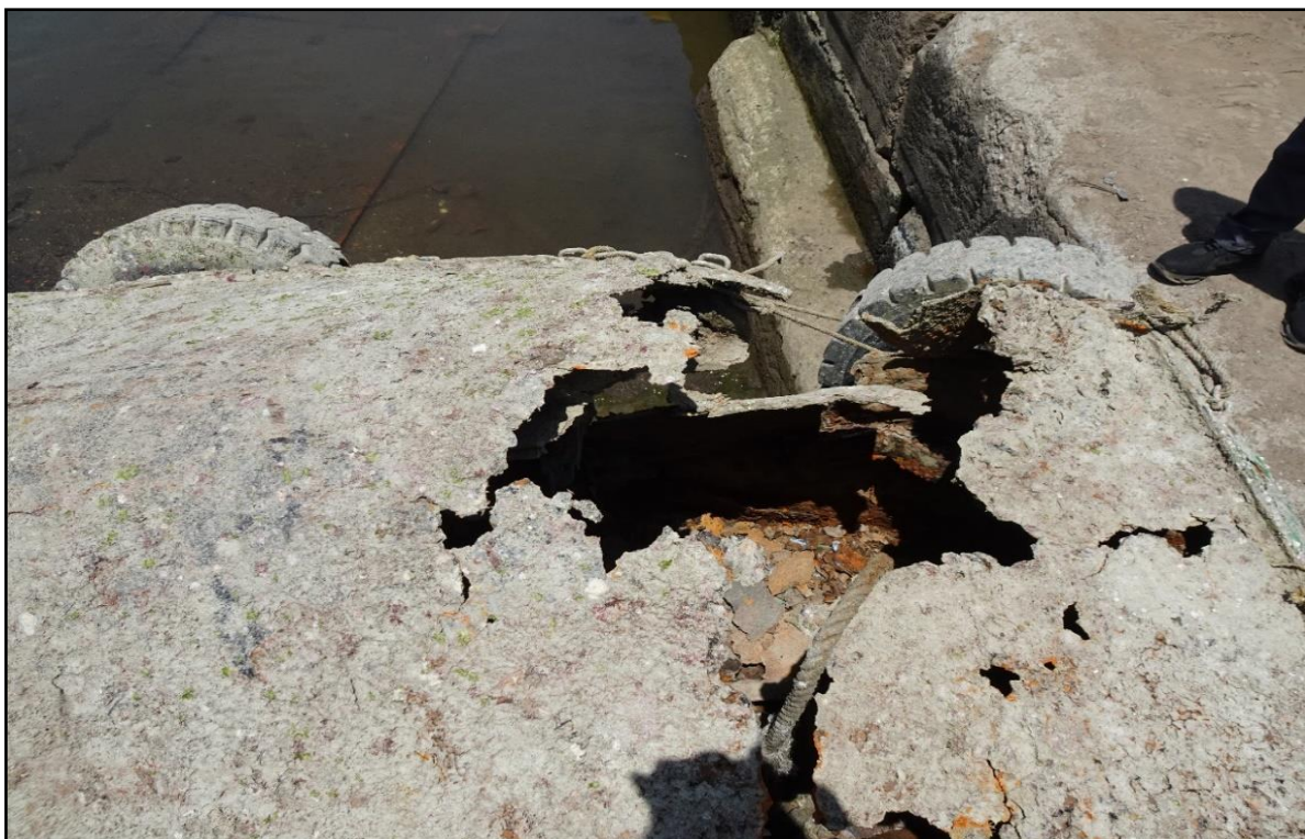
圖 28 東洋 6 號左船艙甲板破損處 (約 65 公分 X 30 公分)
