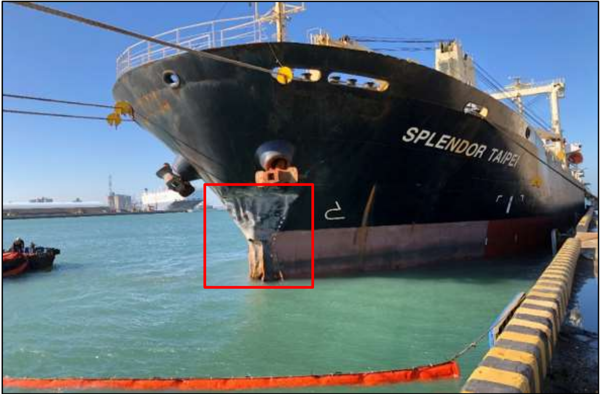
圖 1 榮茂船艙損壞
