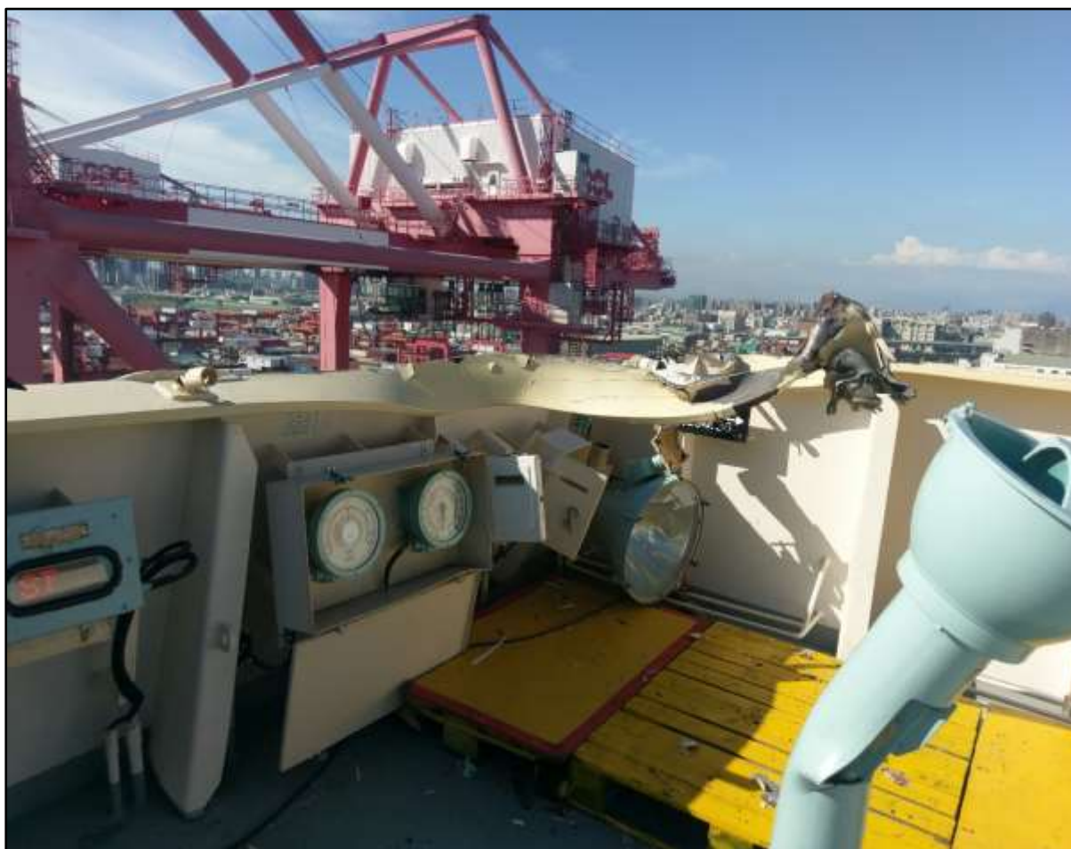
圖 3 東方德班駕駛臺右舷船橋損傷圖
