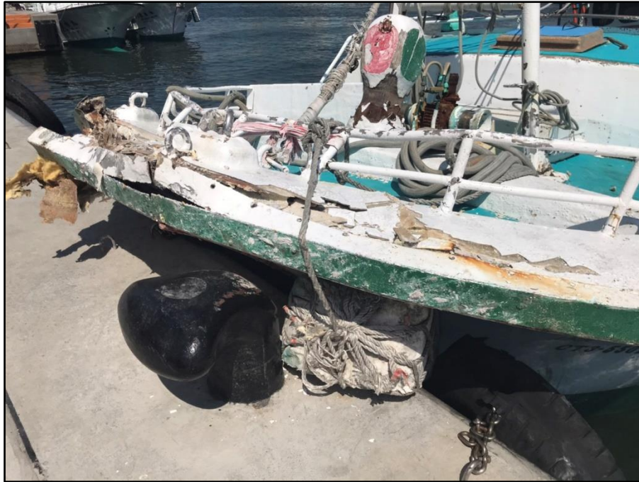
圖 4 滿盈翔漁船損害情形
