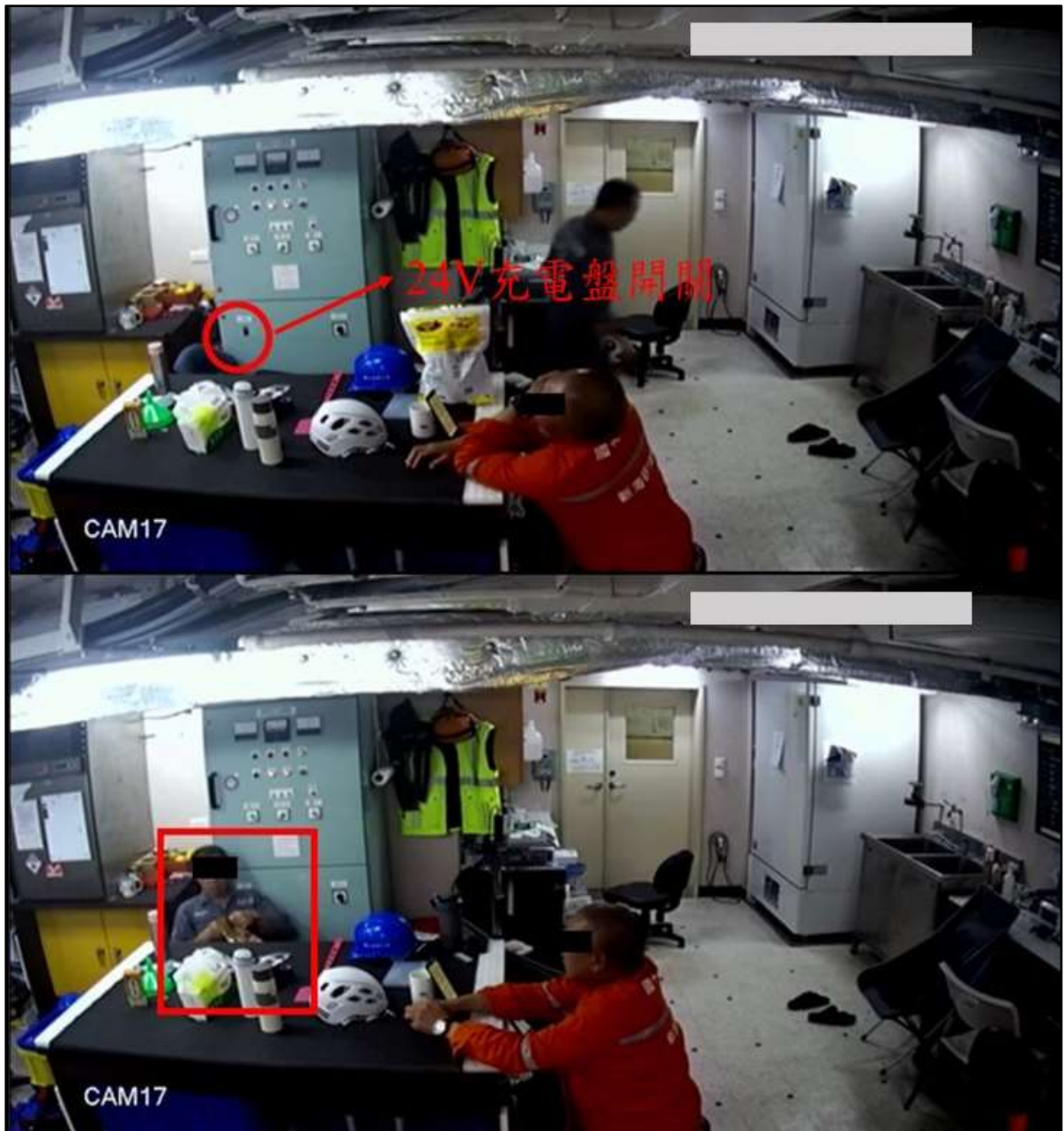
圖 12 隨船作業人員座椅後靠誤觸充電盤主電源開關
