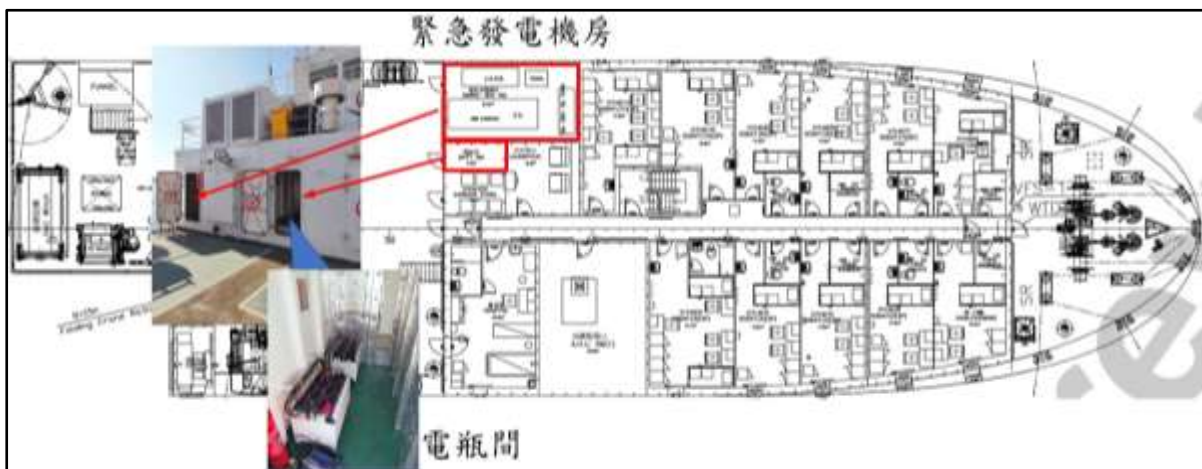
圖 10 充電盤電瓶位置
