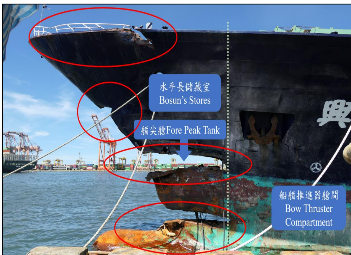
圖 3 船艙受損情形（調查小組現場勘查）
