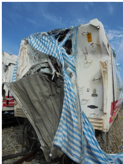
車端受損情形
