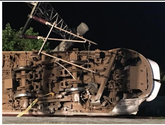
8 車一號轉向架（車頭）（事故當日拍攝照片）
