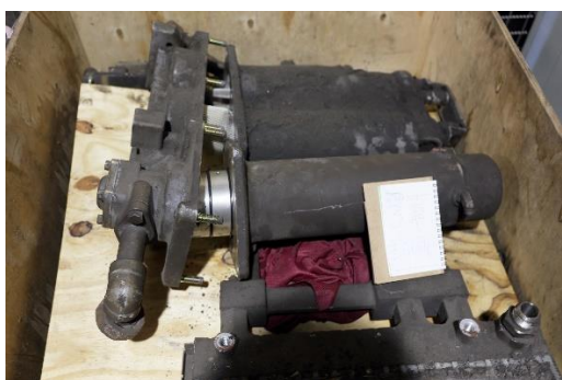
3 車中空絲膜除濕機、油分離器及水分離器
