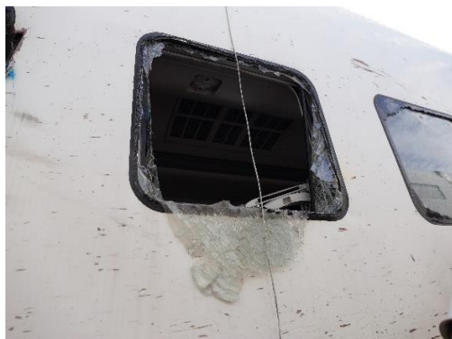
海側車窗碎裂
