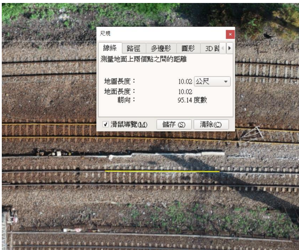
圖 1.10-8 空拍圖 10 公尺長度測量（介曲線）
