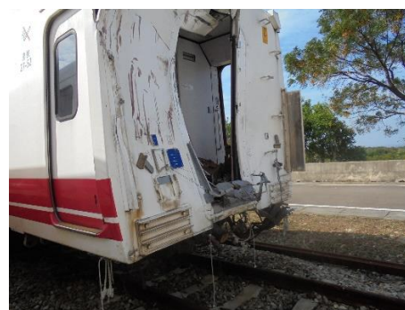
車端受損情形
