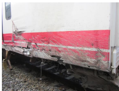
車廂受損情形（海側）
