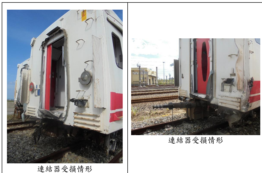
圖 1.3-9 第 6 車連結器損傷概況
