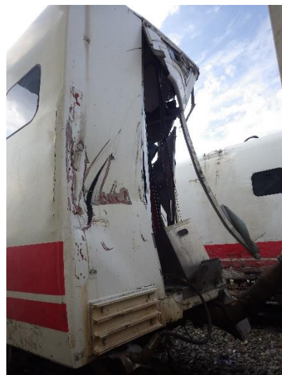
車端受損情形
