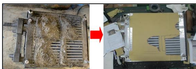
圖 2.2-3 事故列車 1 車冷卻器鰭片狀態模擬
