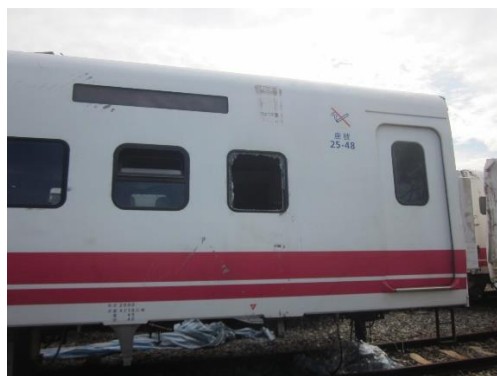
車窗碎裂（山側）
