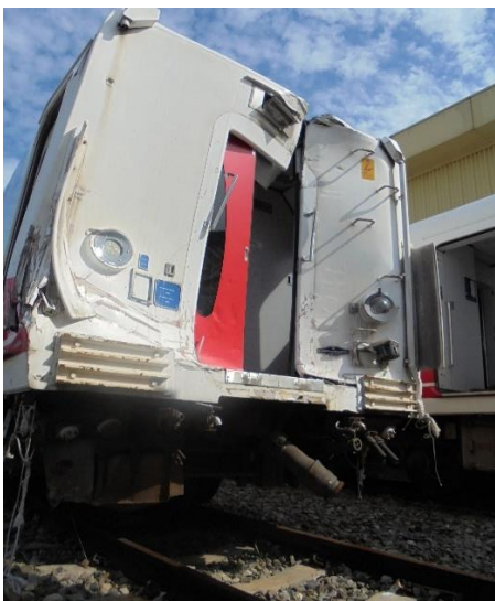
車端受損情形
