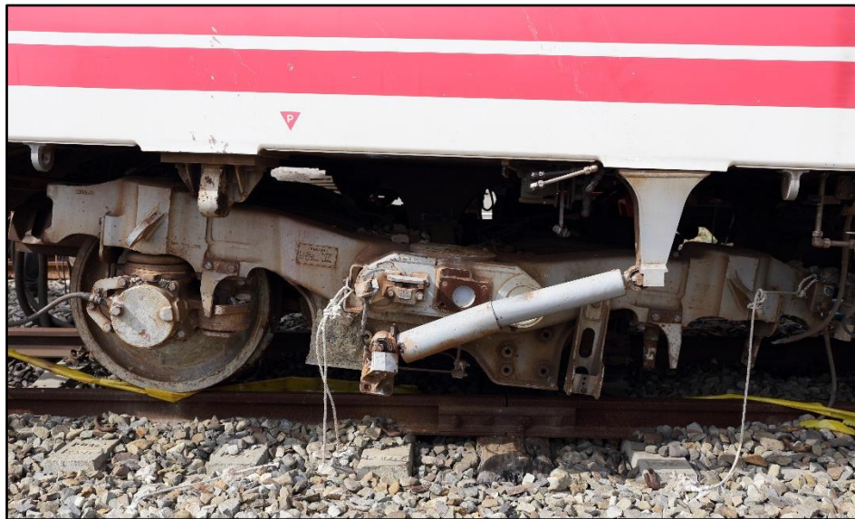
圖 1.3-11 第 6 車轉向架損傷概況圖
