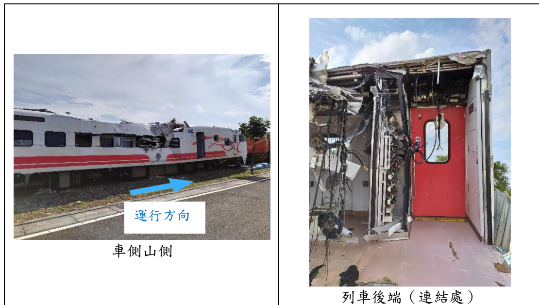
圖 1.3-1 第 8 車車廂損傷概況圖
