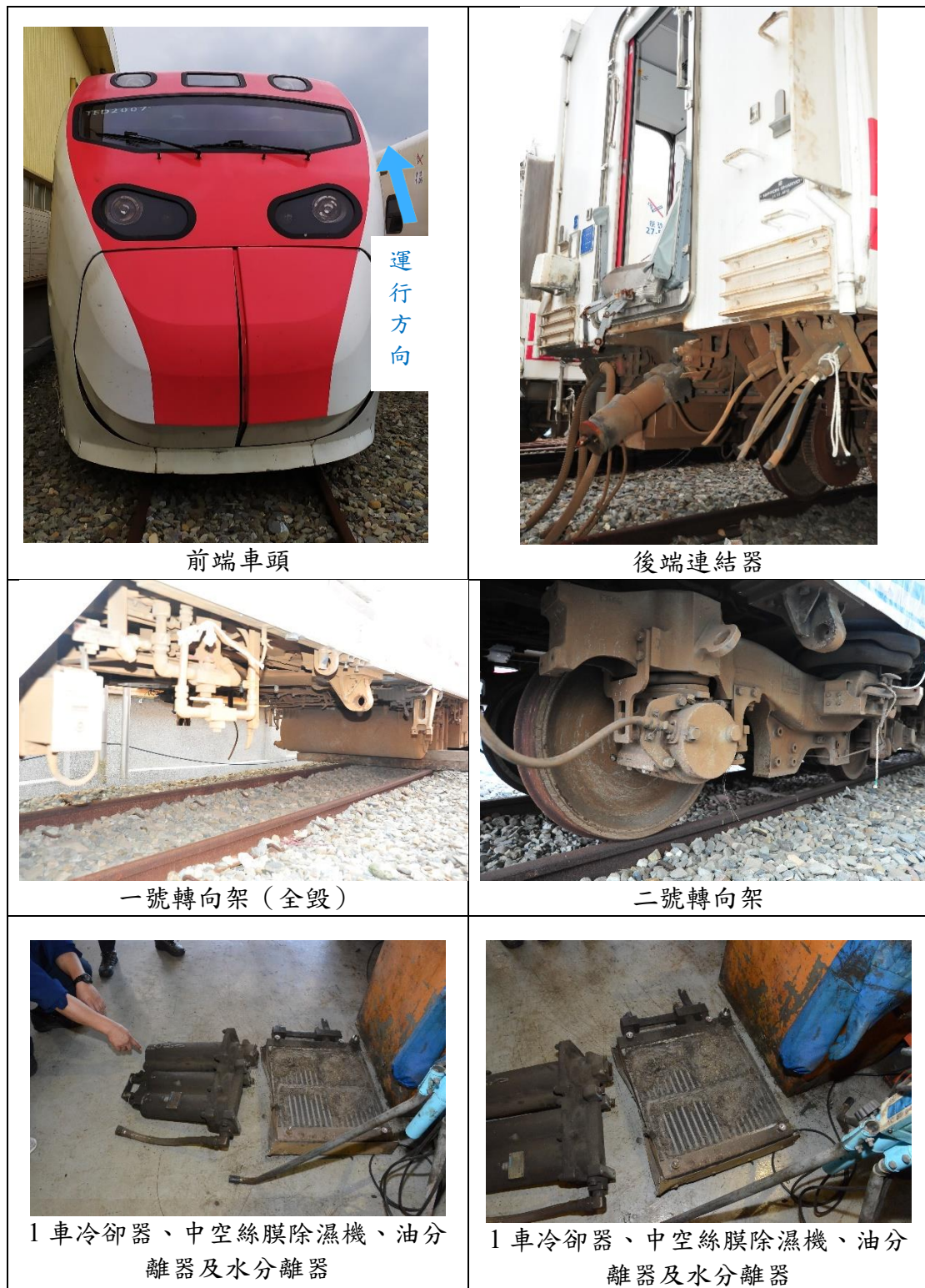
圖 1.3-16 第 1 車損傷概況圖
