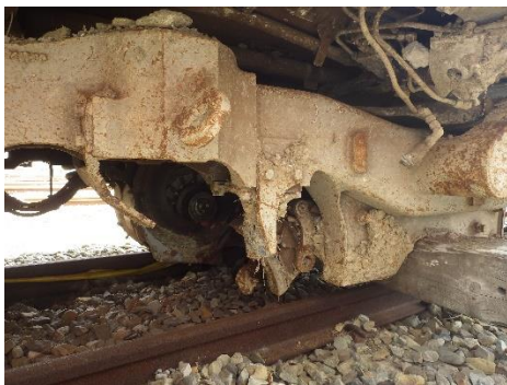
轉向架受損情形
