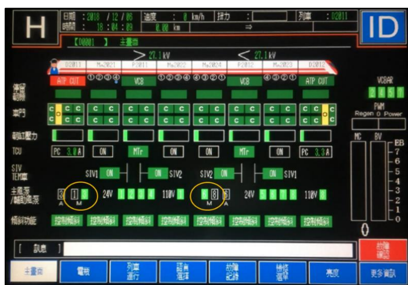
圖 1.7-4 TCMS 駕駛顯示器單元之主風泵運作圖示
