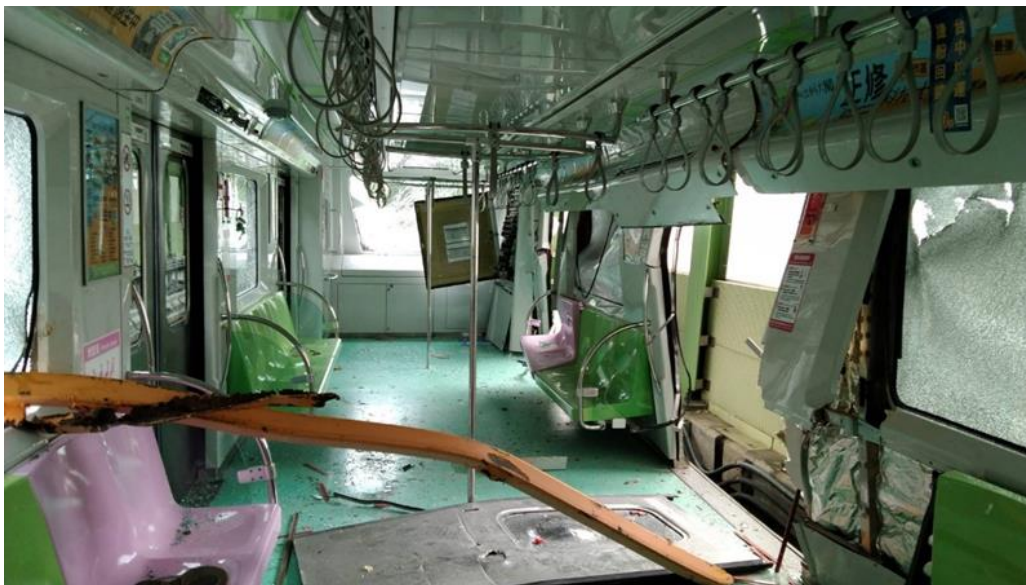
圖 4 桁架撞及列車車門導致脫落並貫穿車窗
