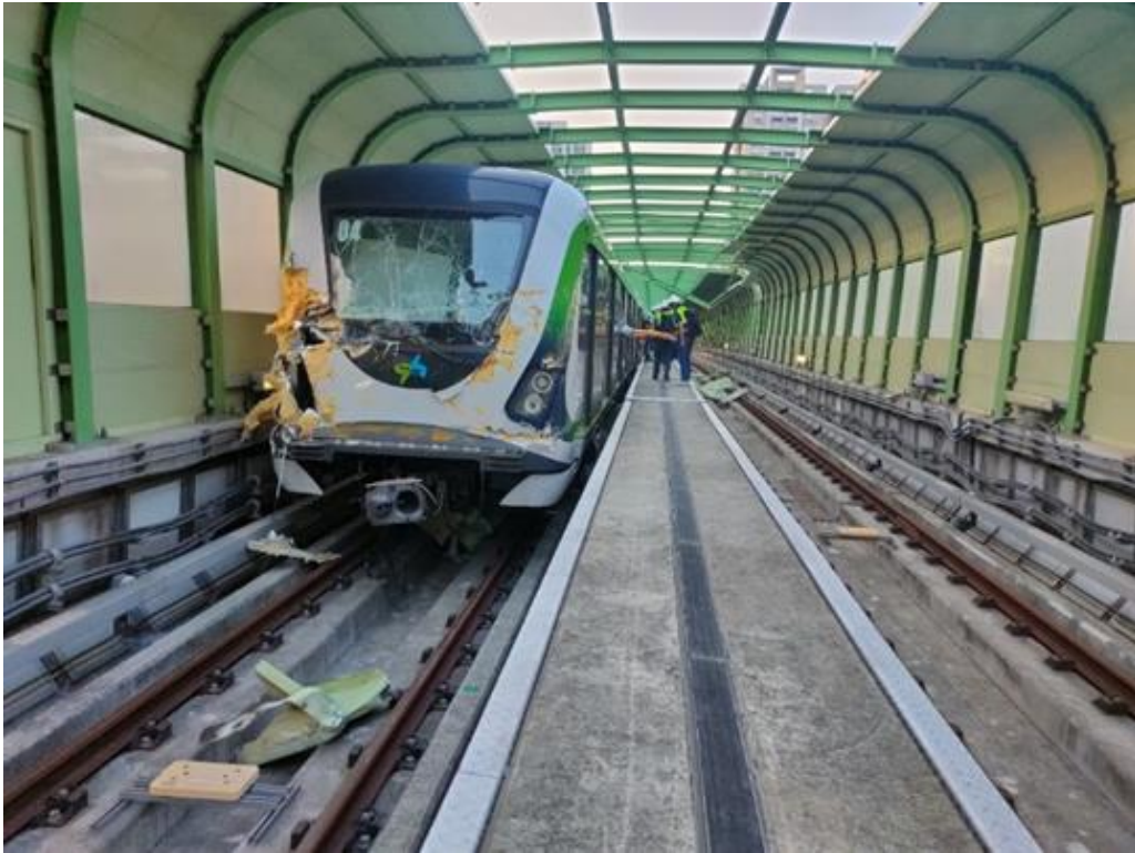
圖 3 列車車頭撞及塔式起重機桁架後毀損
