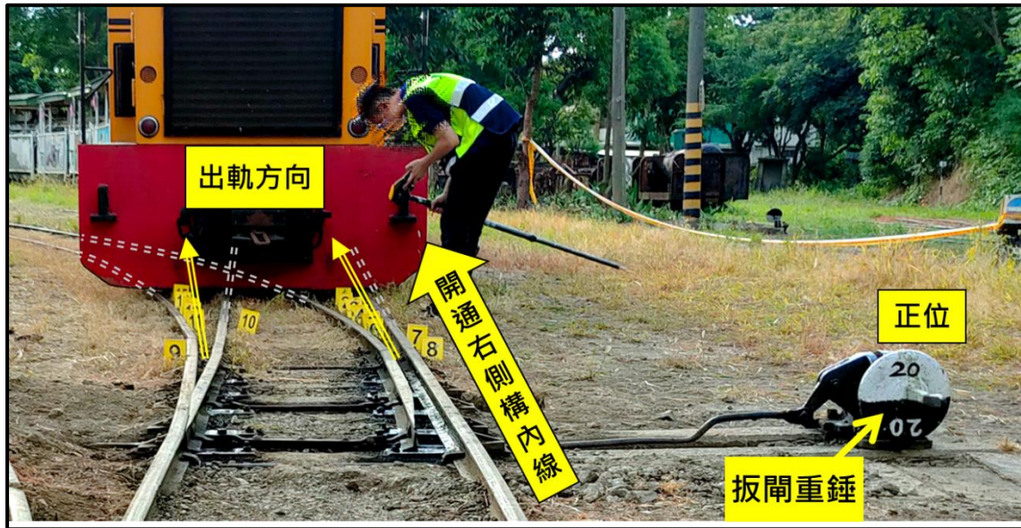
圖 7 第 20 號道岔開通方式示意圖
