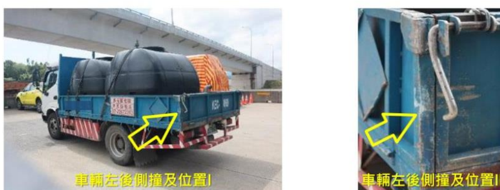
圖 1.4-1 大貨車四視圖及廂式車廂損害情形
