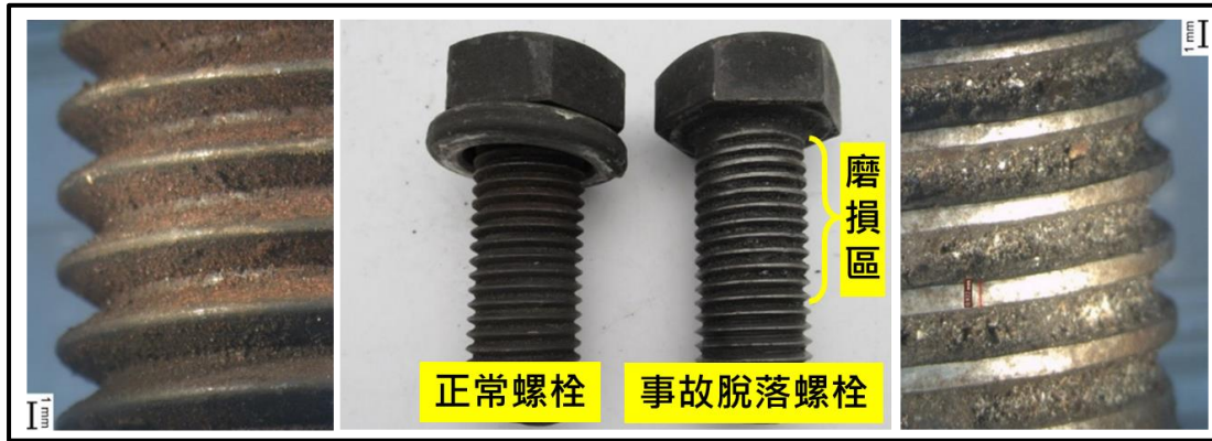
圖 1.10-7 事故脫落螺栓顯微檢視
