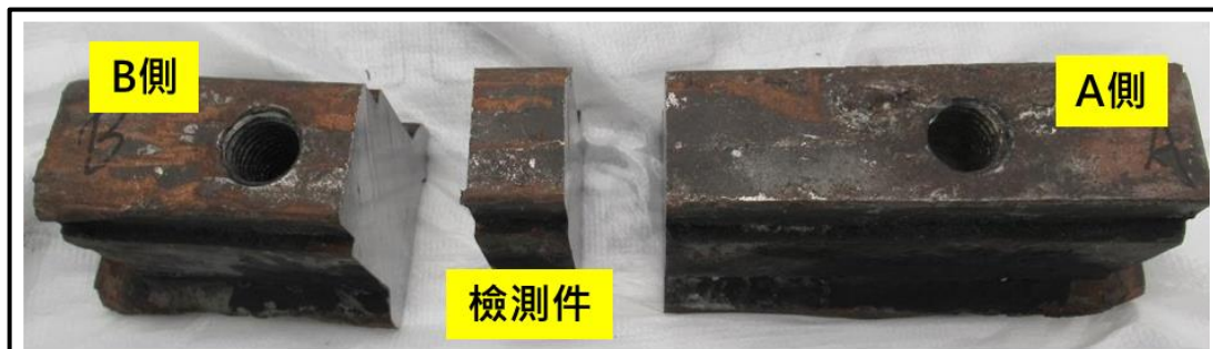
圖 1.10-10 失效件破壞性裁切取樣
