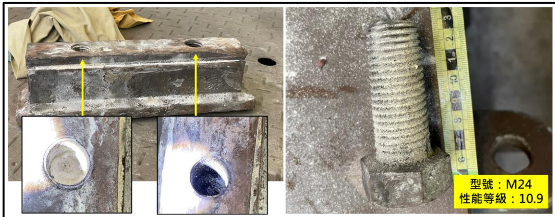
圖 1.9-4 遺落於轉向架上之馬達鞍座及馬達鞍座螺栓
