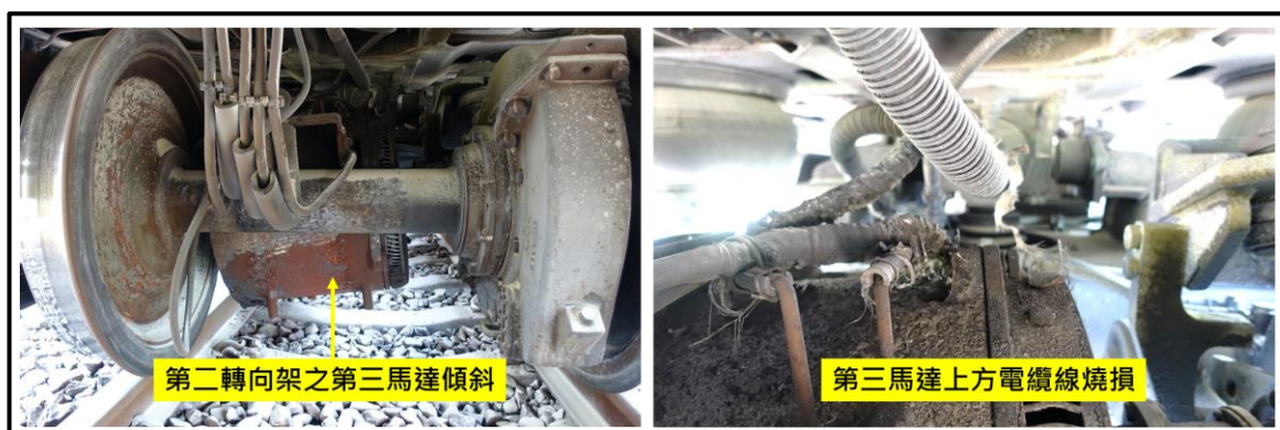
圖 1.3-2 事故列車第 1 車第二轉向架之第三馬達狀況
