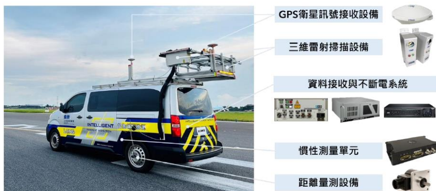
圖 2.1-1 LCMS 鋪面雷射檢測系統
