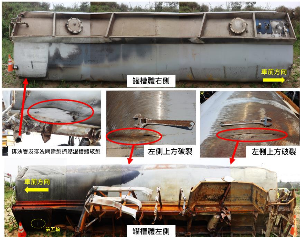
圖 1.2-7 罐槽體受損情形
