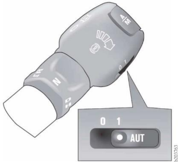
圖 1.15-5 油壓減速器撥桿及自動開關（AUT 按鈕）示意圖
