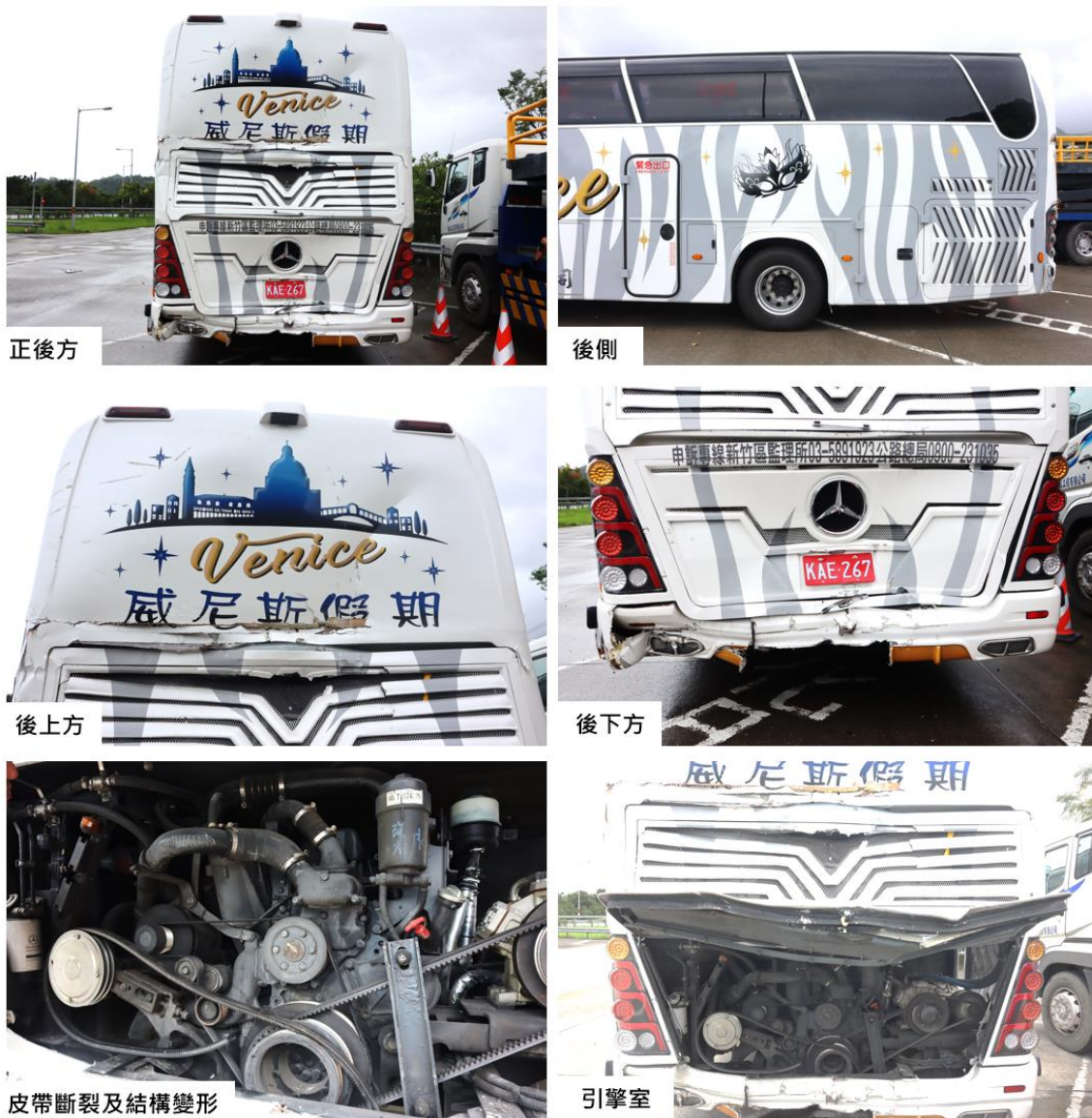
圖 1.4-1 前方遊覽車損害情形
