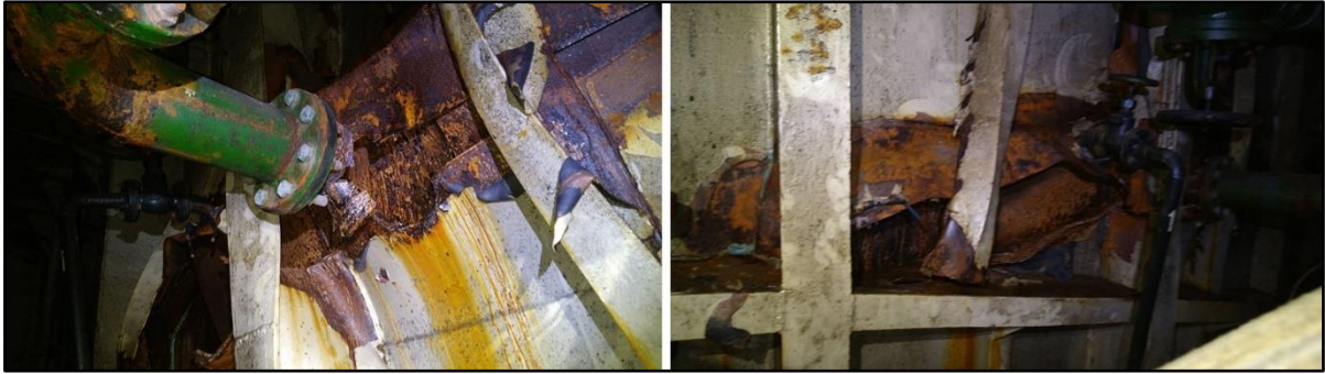
圖 1.3-2 13302 號左舷船體破洞損害情況
