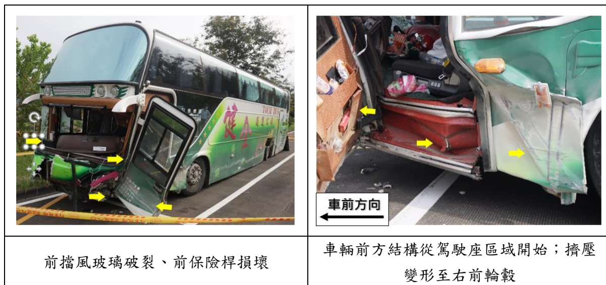
圖 1.3-1 車體損害情形 (1)
