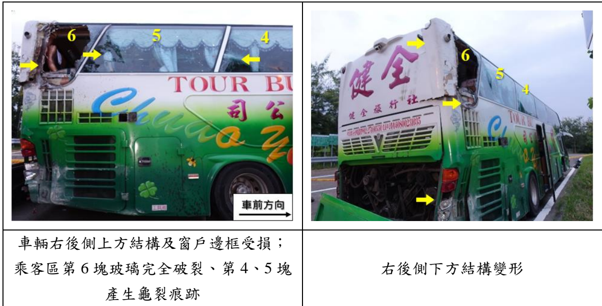
圖 1.3-2 車體損害情形 (2)
