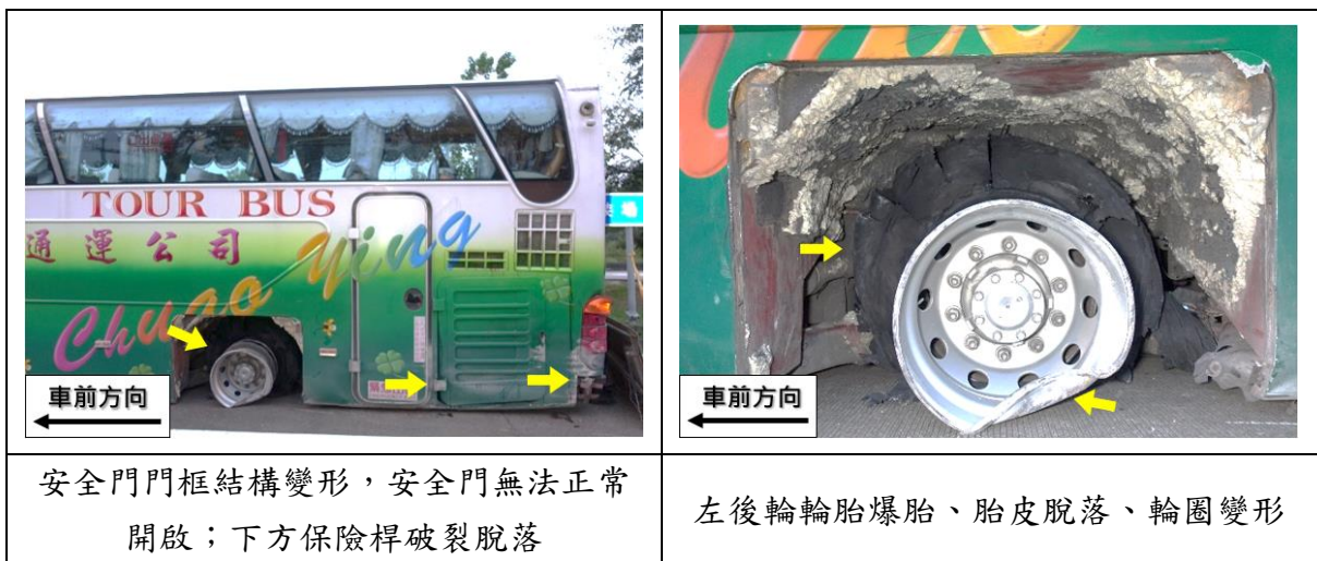
圖 1.3-3 車體損害情形 (3)
